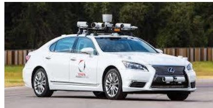
Ilustración 6: Cámaras en un coche autónomo
