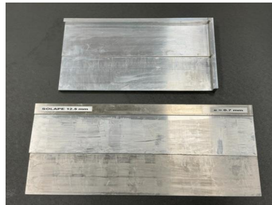
Ilustración 3-15: Útil de colocación de las probetas para su preparación [30]
