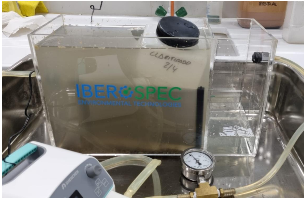
Figura 2 - Proceso de filtrado de muestra de clarificado, 21 de mayo de 2025, (Elaboración propia)
