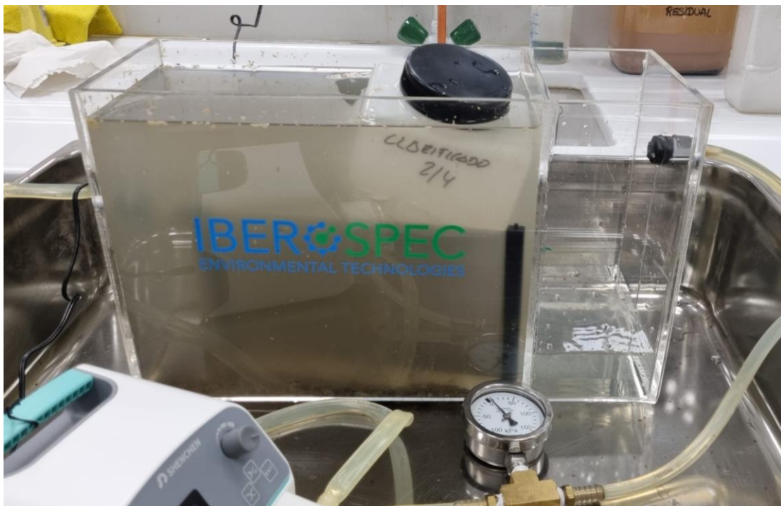
Ilustración 28 - Proceso de filtrado muestra de clarificado, 21 de mayo de 2025, (Elaboración propia)
