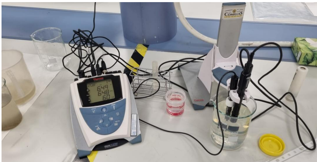
Ilustración 30 - Medida de conductividad, pH y oxígeno disuelto de la muestra posterior al filtrado, 21 de mayo de 2025, (Elaboración propia)
