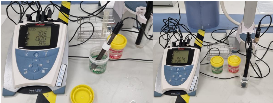
Ilustración 15 - Calibración del pH-metro (izquierda) y del electrodo selectivo de conductividad (derecha) (Elaboración propia)
