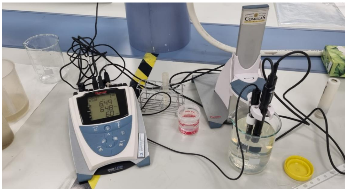
Ilustración 16 - Ejemplo de medición de pH, conductividad y oxígeno disuelto (Elaboración propia)
