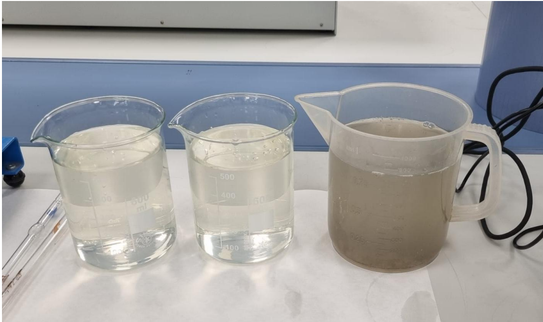
Ilustración 31 - Imagen del ensayo final, comparando el permeado (izquierda) y la muestra sin filtrar (derecha), (Elaboración propia)
