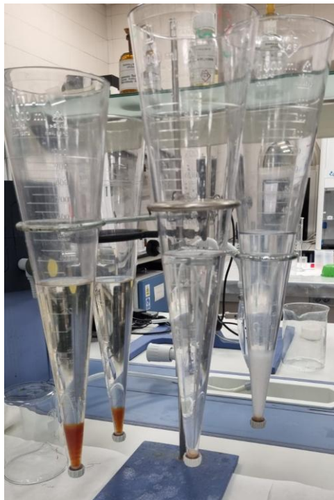
Ilustración 23 - Imagen de los volúmenes de flóculos formados en el análisis del permeado, 7 de marzo de 2025, (Elaboración propia)
