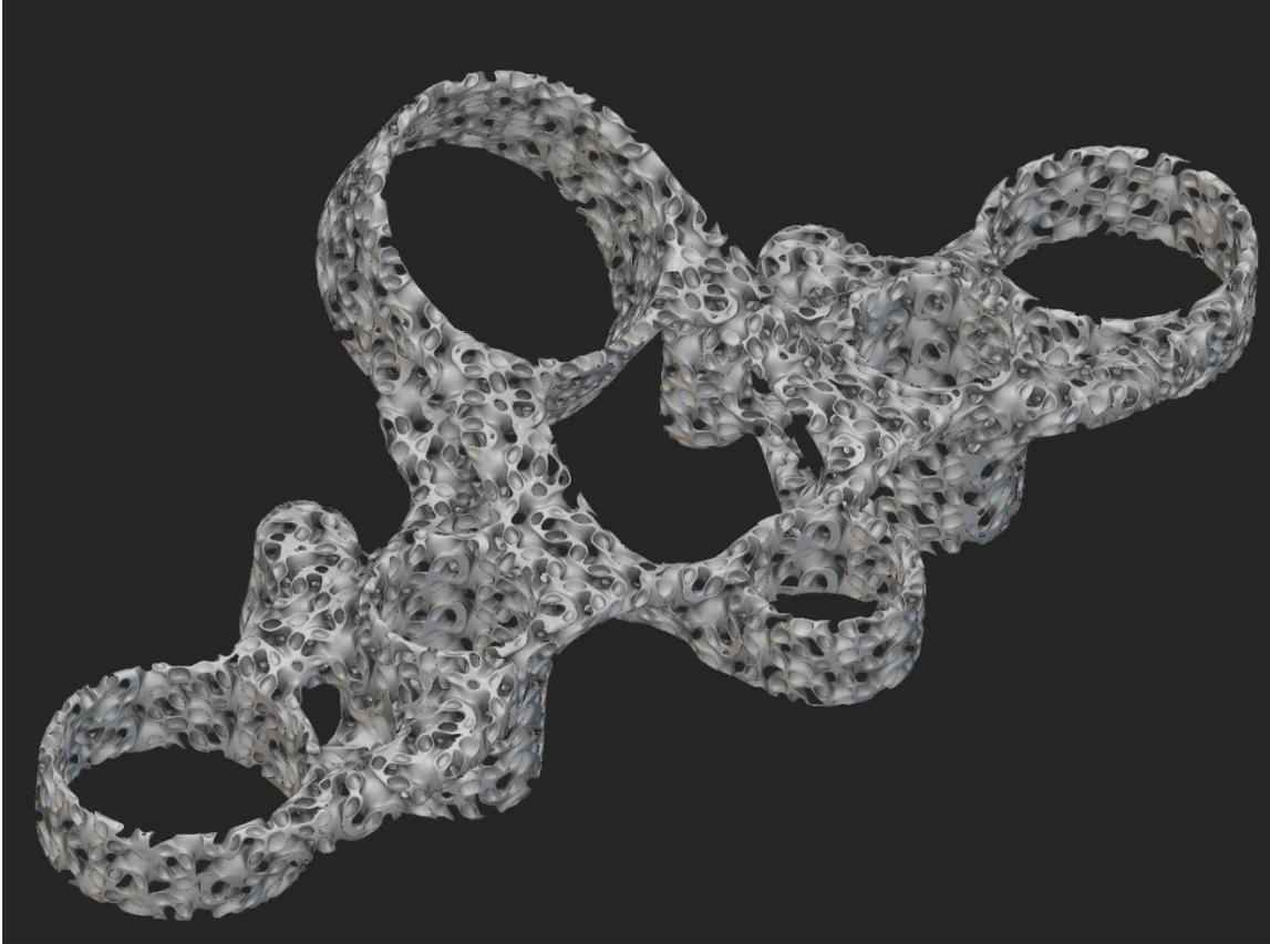
*Figura 151 Estructura lattice 4 sin borde*
