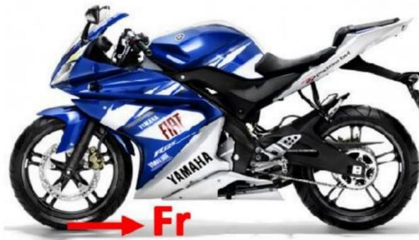
Figura 86 Fuerza de rozamiento, reacción sufrida por la motocicleta en la frenada.
