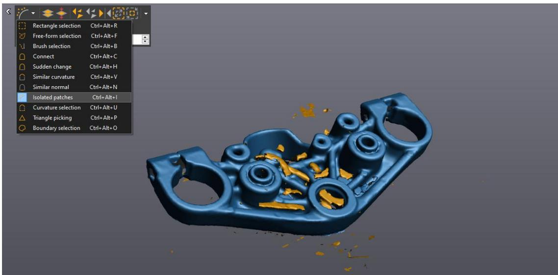
Figura 45 Detalle de la herramienta de selección de *Isolated patches* en la malla de puntos 3.
