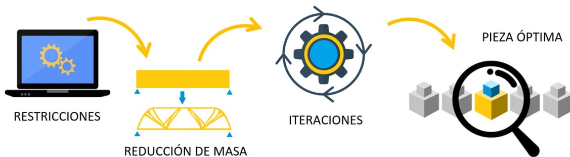
*Figura 12 Detalle del diagrama de flujo de la Optimización Topológica con criterios de diseño generativo.*
