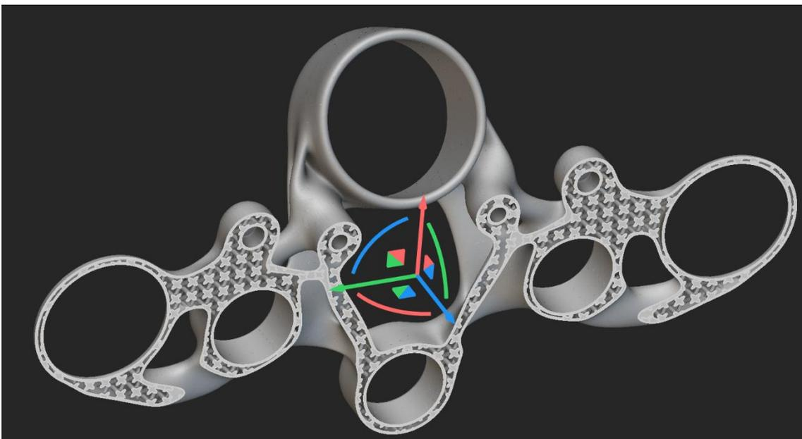
Figura 138 Tija optimizada, refinada y rellena con Lattice 1.
