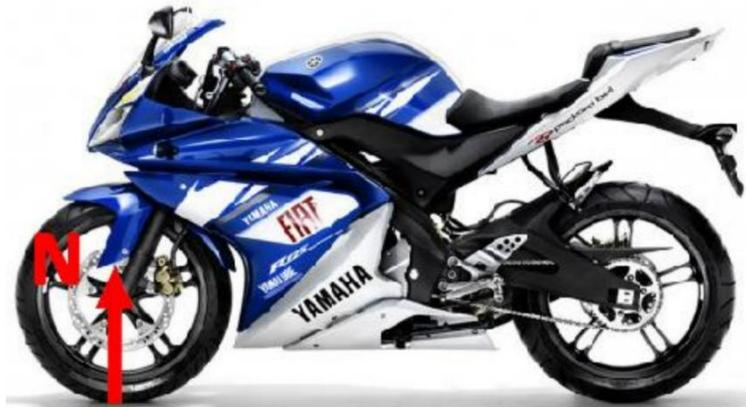
Figura 84 Fuerza normal, reacción sufrida por la motocicleta en la frenada.
