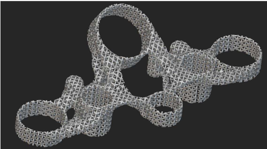
Figura 136 Estructura lattice 1 sin borde
