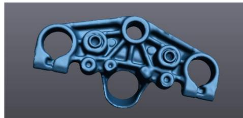
*Figura 3 Proceso de ingeniería inversa de la tija: escaneo 3D con VX Elements.*
