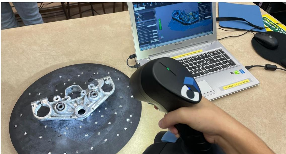
*Figura 35 Detalle del escaneo de la parte inferior de la pieza.*
