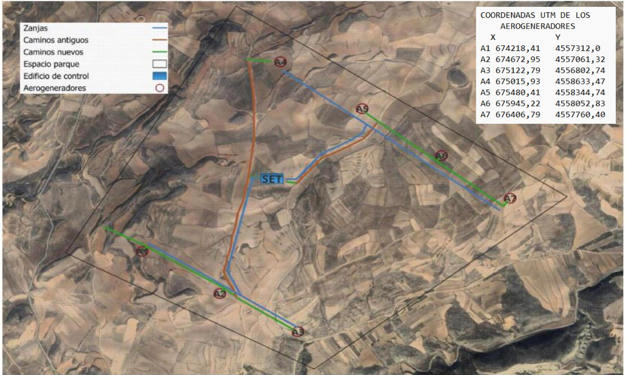
COORDENADAS UTM DE LOS AEROGENERADORES
