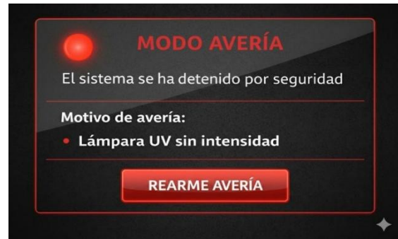
Ilustración 20. Pantalla de avería y parada de seguridad
