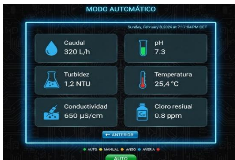
Ilustración 17: Pantalla supervisión de parámetros
