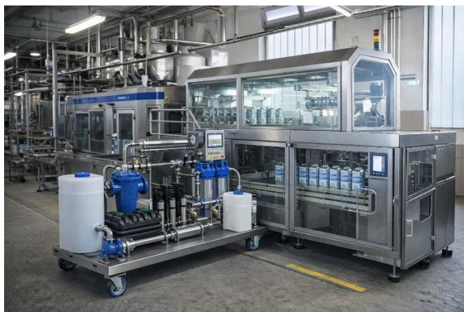
Ilustración 12: Integración del sistema de llenado con el sistema de esterilización Elaboración Propia
