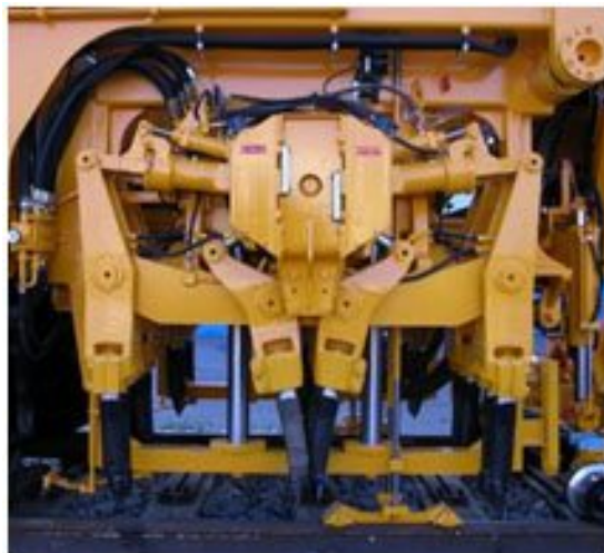
Figura 9. Bateo de dos traviesas
