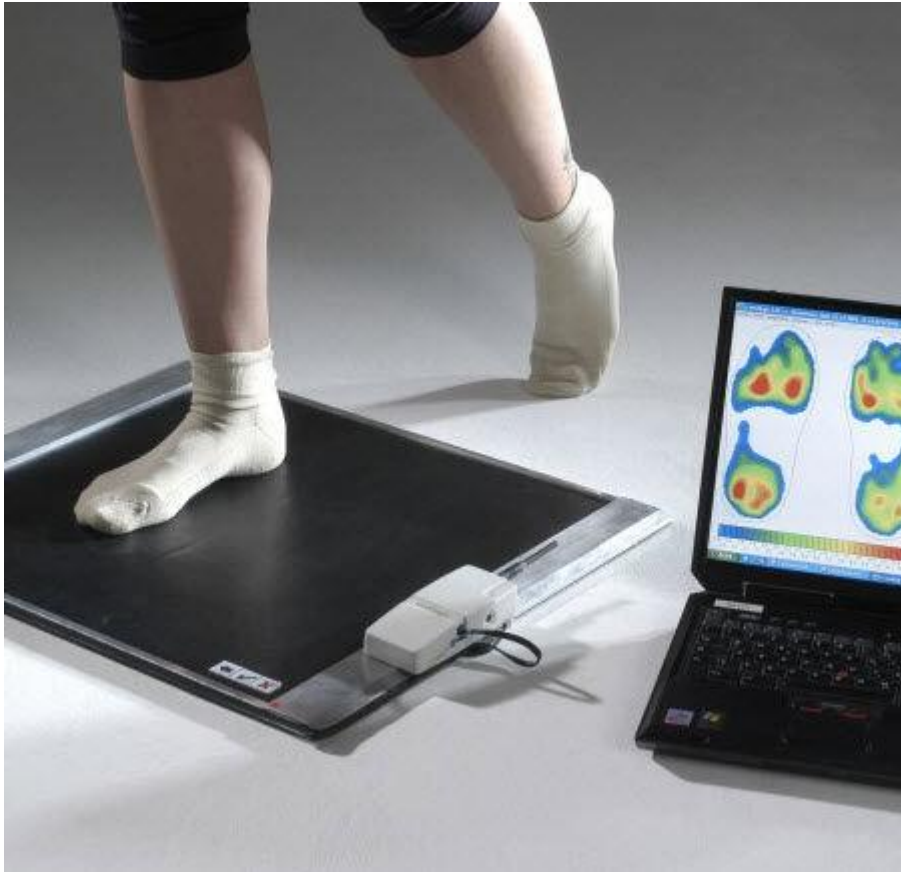
Figura 4: Sistema de plataforma de presiones.
