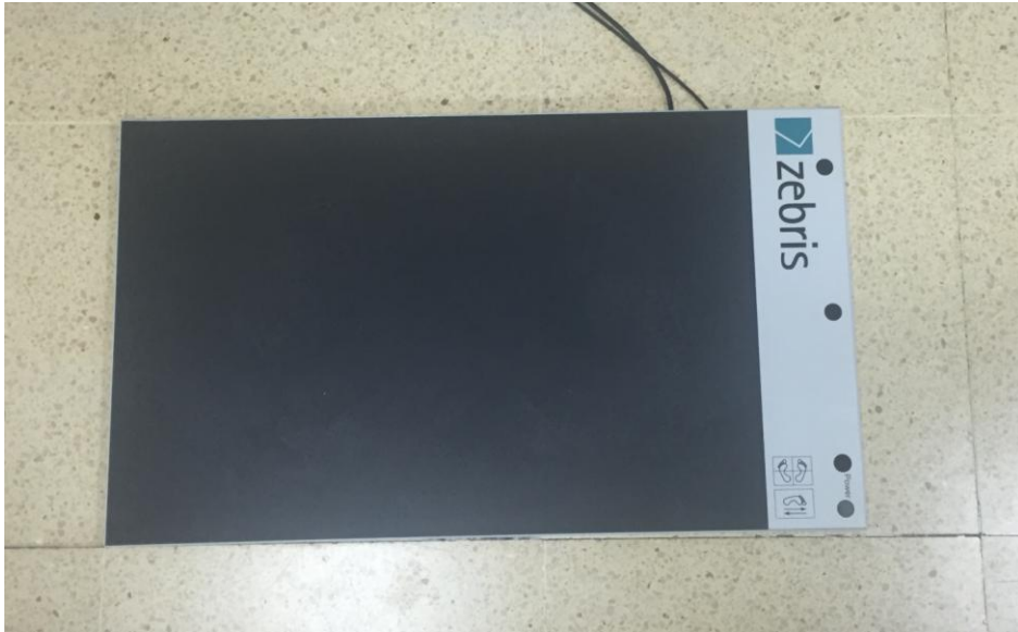
Figura 10: Plataforma de presiones Zebris.
