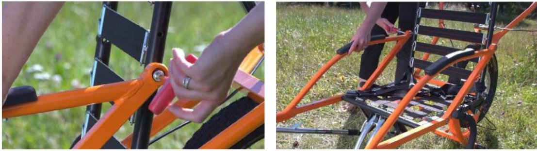
Figura 5.1 Reposabrazos y asas de la silla de ruedas Joëlette. Fuente: Manual de usuario de la silla de ruedas Joëlette, 2018.
