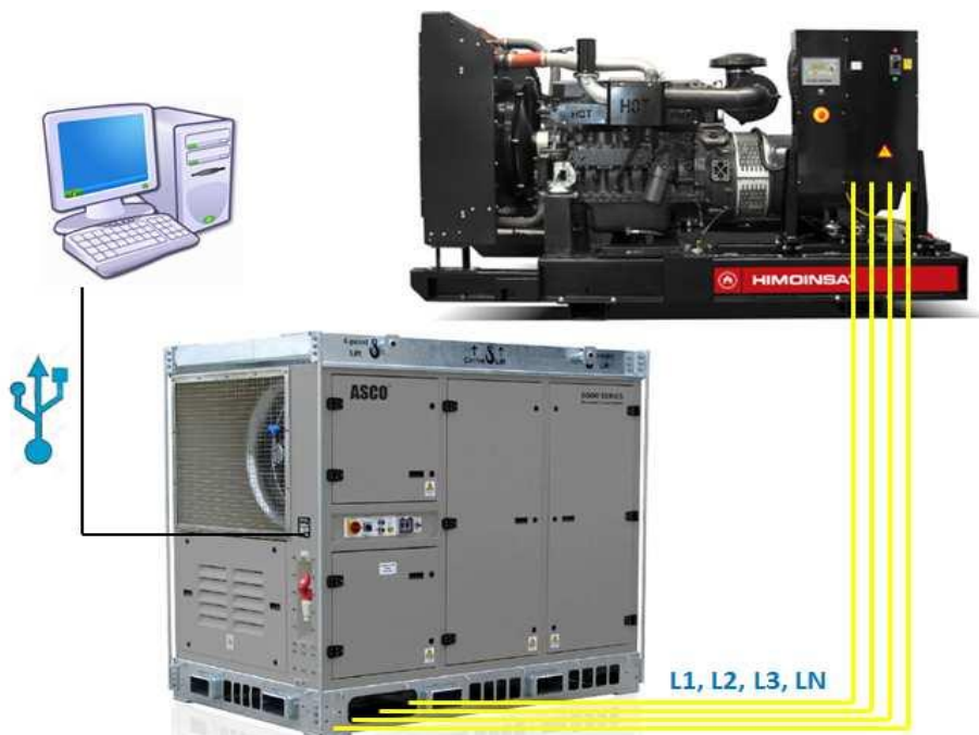
Figura 20. Esquema de conexión para la prueba de impactos de carga
