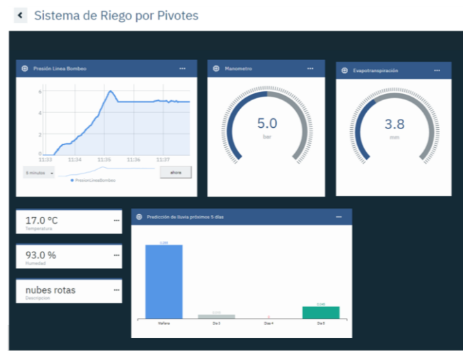
Ilustración 6: Panel de supervisión del Sistema de Riego por Pivotes
