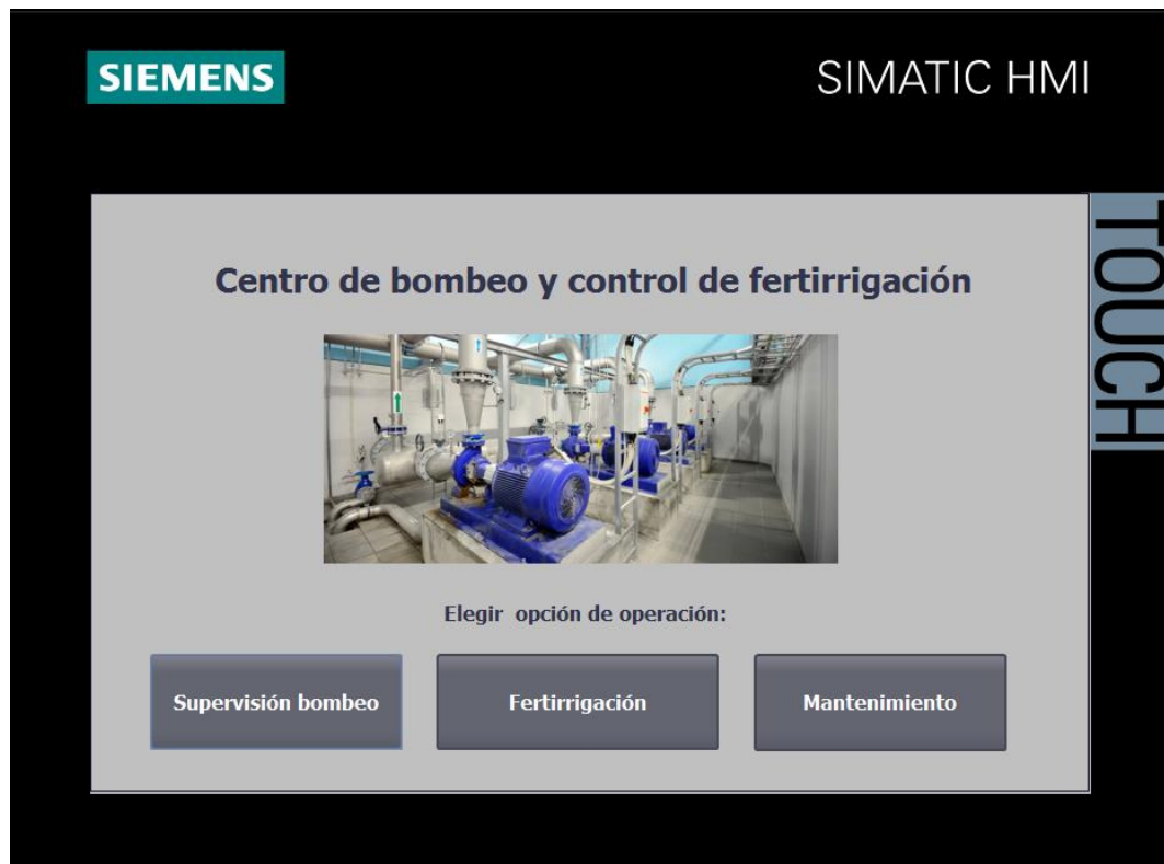
Ilustración 33: Imagen Principal control bombeo SIMATIC HMI Siemens
