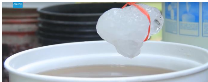
ILUSTRACIÓN 6 (PASO 1) CLARIFICACIÓN DEL AGUA CON ALUMBRE
