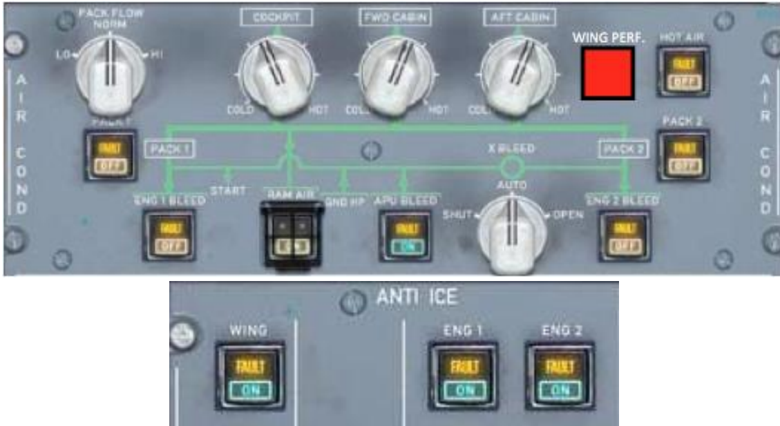
Figura 50. Cuadro de mandos del aire acondicionado y del sistema anti-hielo con botón adicional Wing Perf. Fuente: editada de (Surcando los Cielos, 2018)
