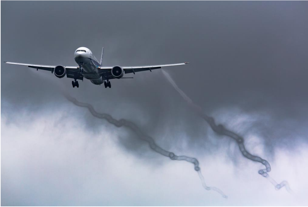
Figura 37. Avión comercial con generación de vórtices en las alas. Fuente: (Ryoh Ishihara)
