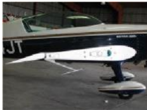
Figura 14. Detalle del perfil alar simétrico del modelo Extra EA-300. Fuente: (Bazán Mejía, 2013)
