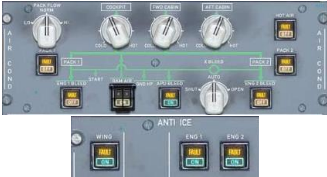
Figura 47. Cuadro de mandos del aire acondicionado y del sistema anti-hielo. Fuente: (Surcando los Cielos, 2018)
