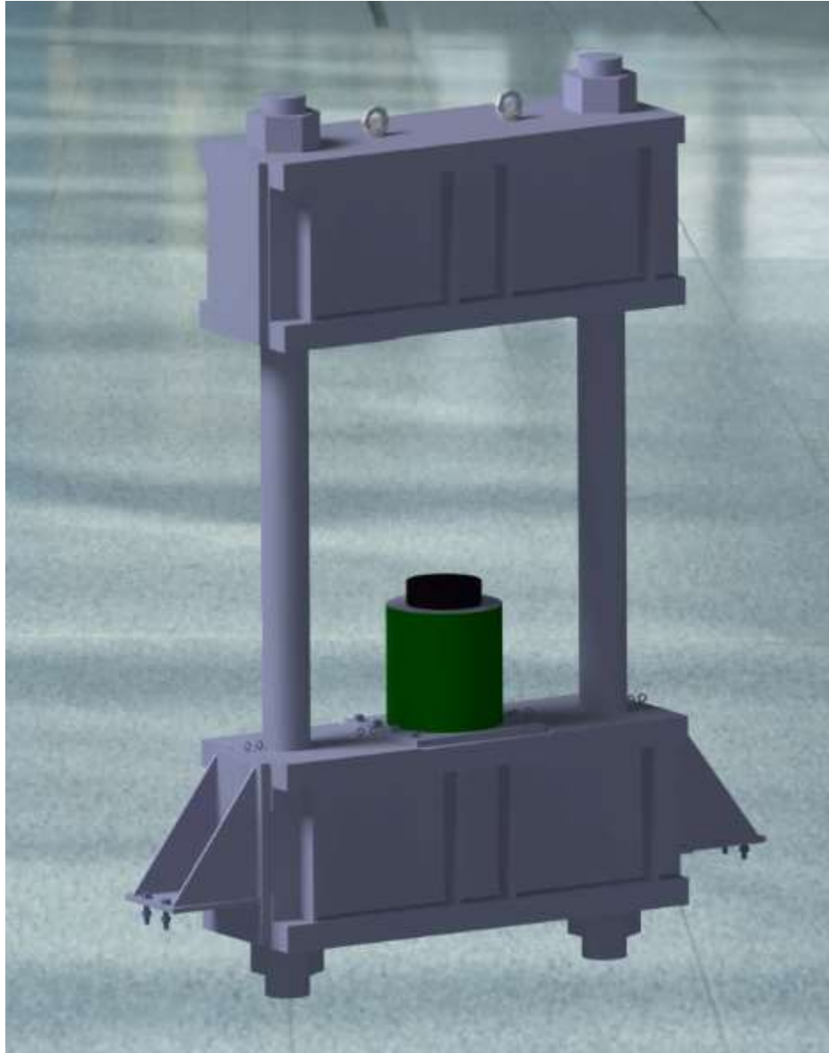
Imagen 4. Diseño 3D del diseño de 1 módulo de la prensa
