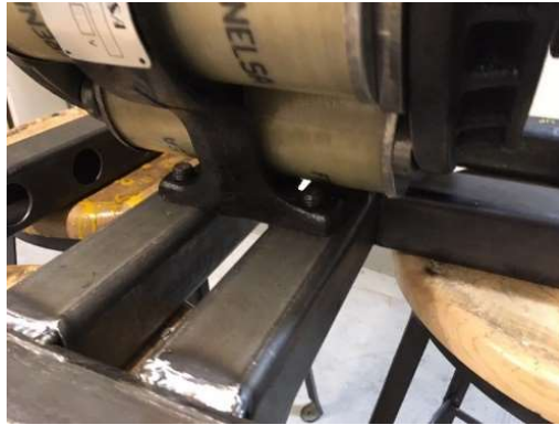
Figura 54. Detalle tornillos base del freno
