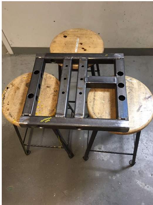
Figura 51. Primer paso del proceso de soldadura
