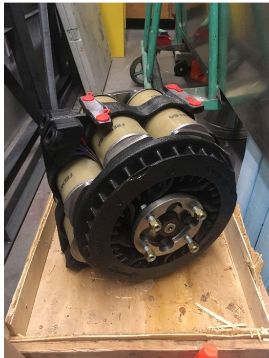
Figura 11. Freno eléctrico de Cooper Union
