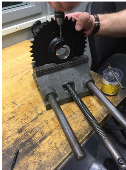
Figura 38. Roscado de la rueda dentada del eje de rodillos
