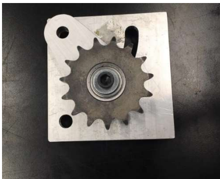
Figura 46. Vista frontal sistema de tensión
