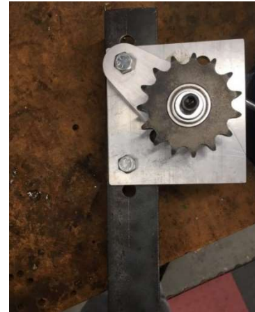
Figura 49. Ensamblaje sistema de tensión
