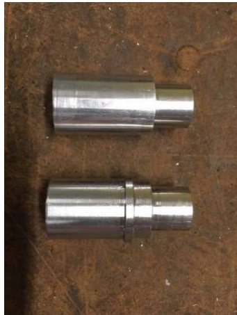
Figura 45. Eje sistema de tensión
