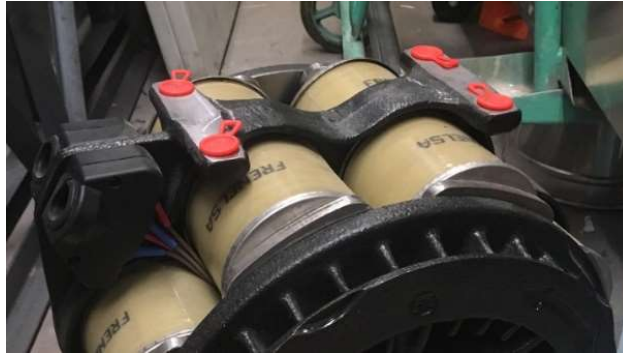
Figura 17. Localización de los tornillos en el freno eléctrico
