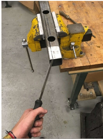
Figura 33. Lijado de barra de la estructura
