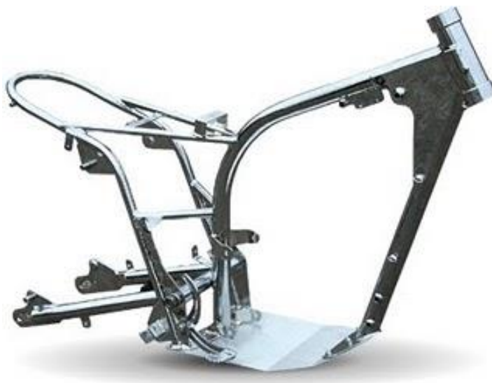
Ilustración 21: Chasis de cuna simple
