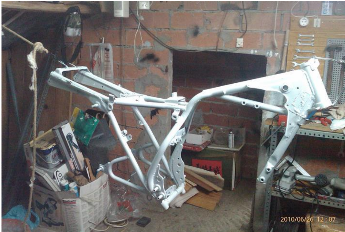
Ilustración 65: Chasis Yamaha SR250
