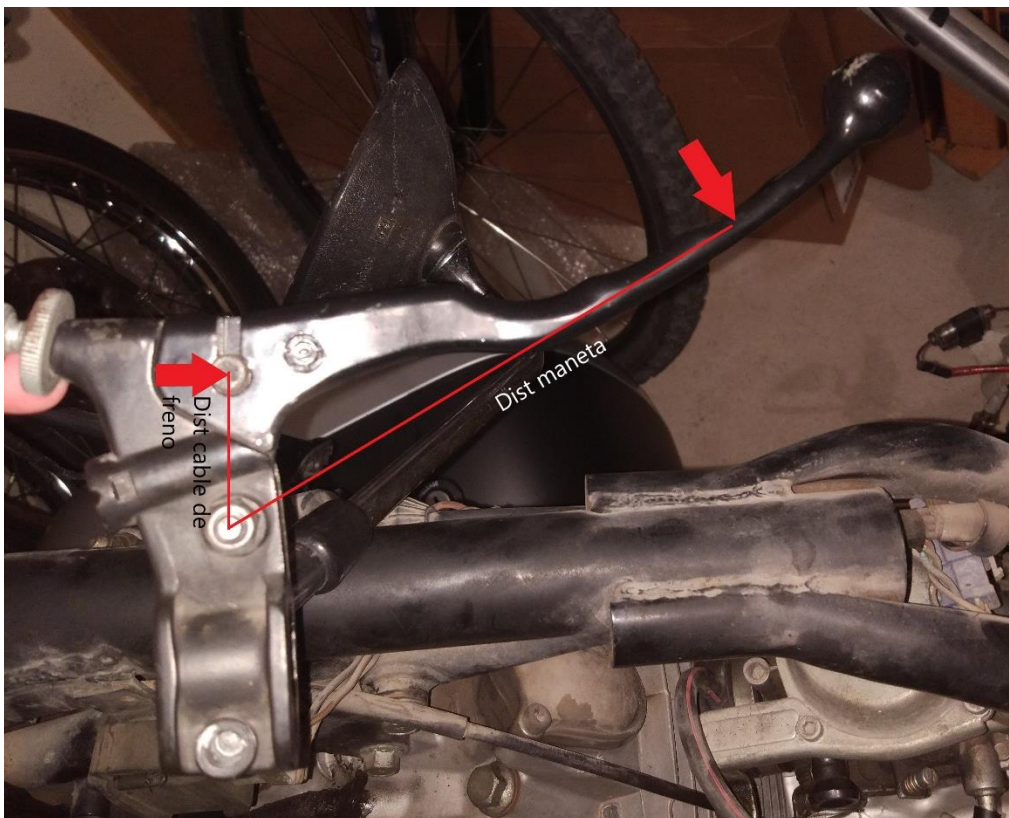
Ilustración 61: Relación de freno de la maneta
