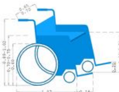
Figura 5.3 Medidas estándar de una silla de ruedas. Fuente: Manual con las medidas básicas para la construcción accesible, 2008
