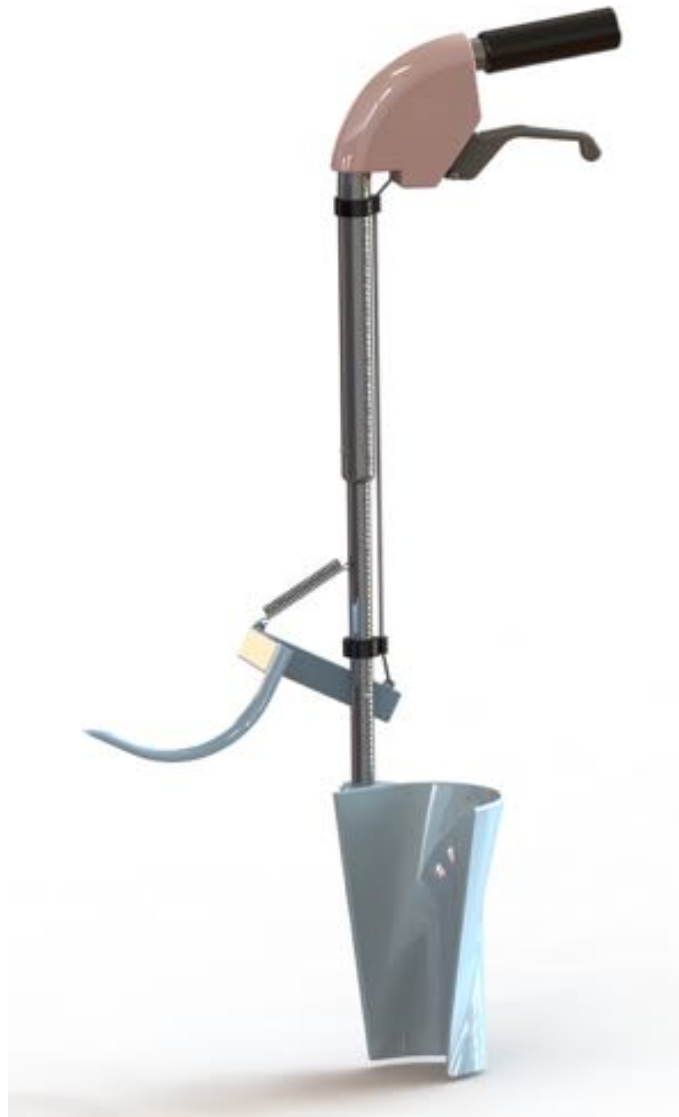
Figura 6.1 Diseño definitivo del calzador realizado con SolidWorks. Fuente: Elaboración propia, 2018
