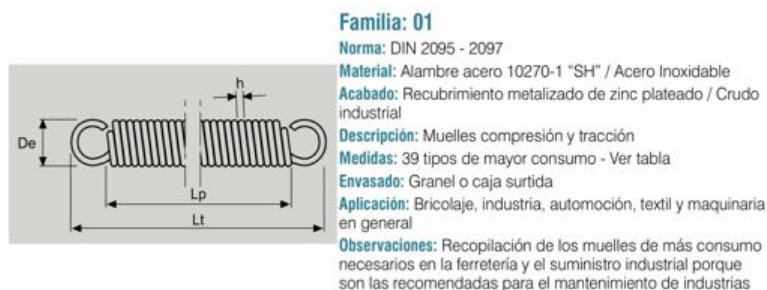
Figura 5.5 Información del tipo de muelle elegido. Fuente: Catálogo de Steel Mefobo, 2017
