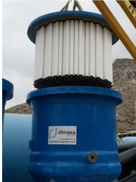
Figura 19. Filtro de cartuchos de la desaladora de Escombreras, (Fuente: Dimasa grupo)
