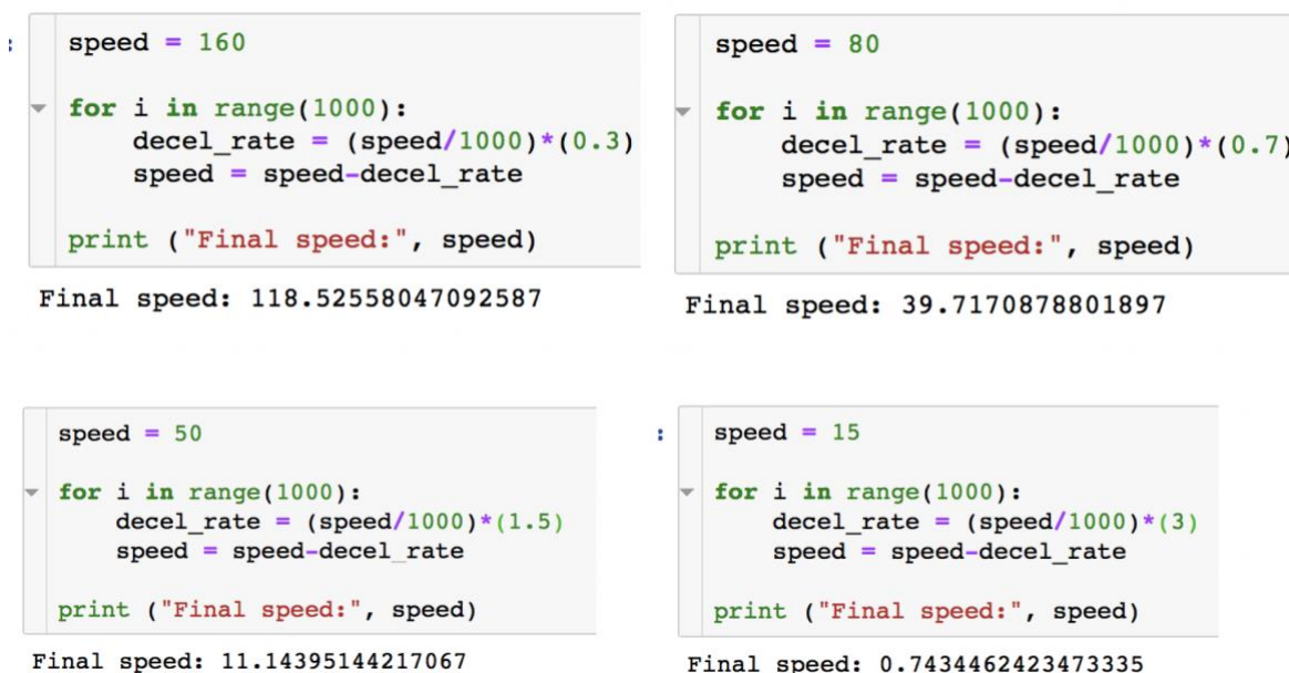
Figura 69 – Ejemplos de cálculo de velocidad de referencia al soltar el puño acelerador en función de la velocidad actual
