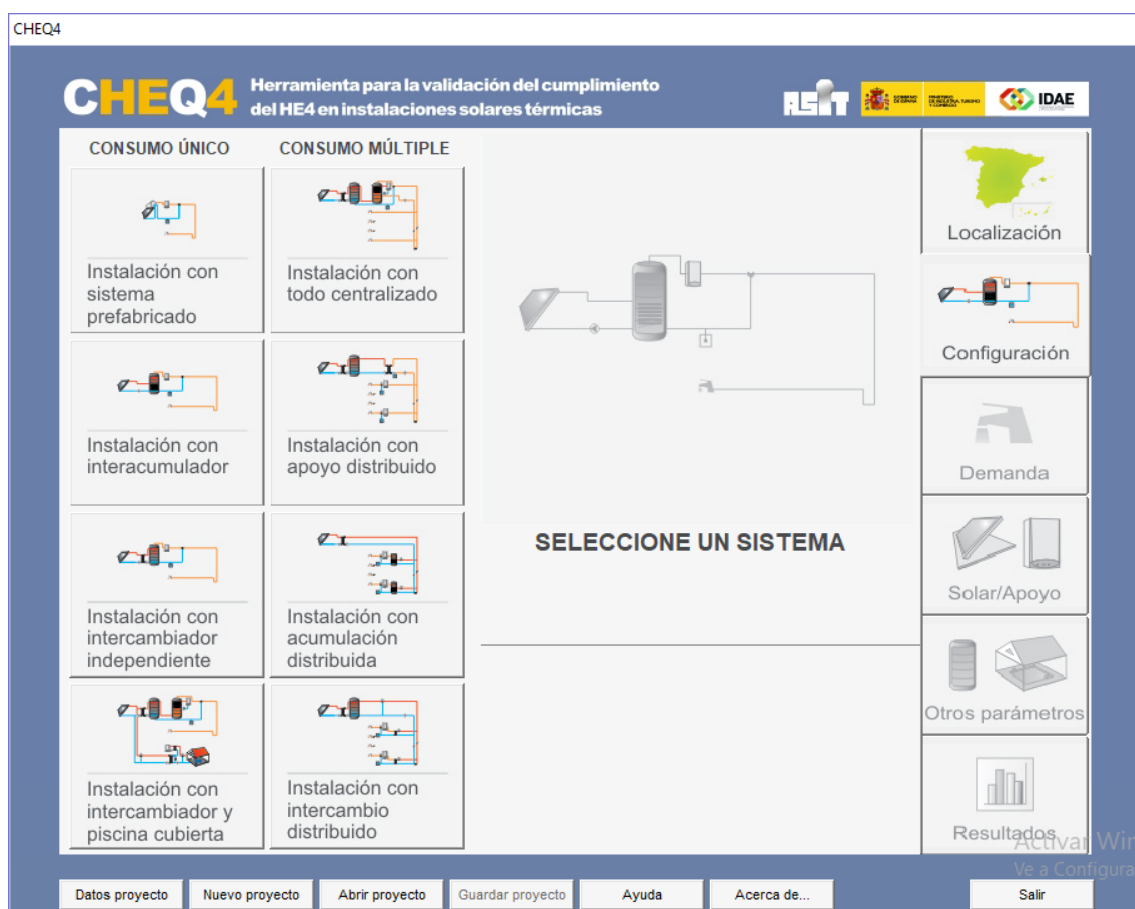
Figura 12. Configuración de la instalación en CHEQ4
