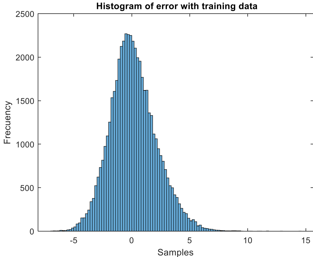
Figura 41. Modelo de la red neuronal RBF. Comportamiento de la temperatura de los anillos del generador con datos de entrenamiento. Histograma gaussiano del error del modelo
