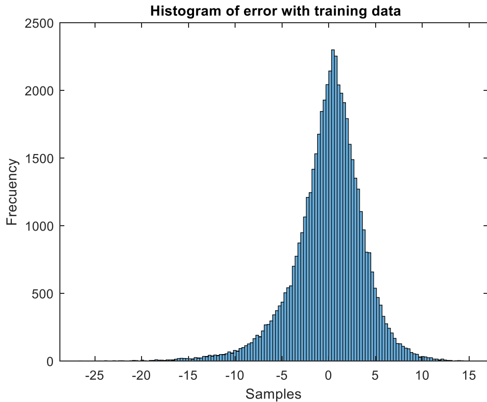
Figura 17. Modelo de la red neuronal perceptrón multicapa. Comportamiento de la temperatura del rodamiento NDE del generador con datos de entrenamiento. Histograma gaussiano del error del modelo
