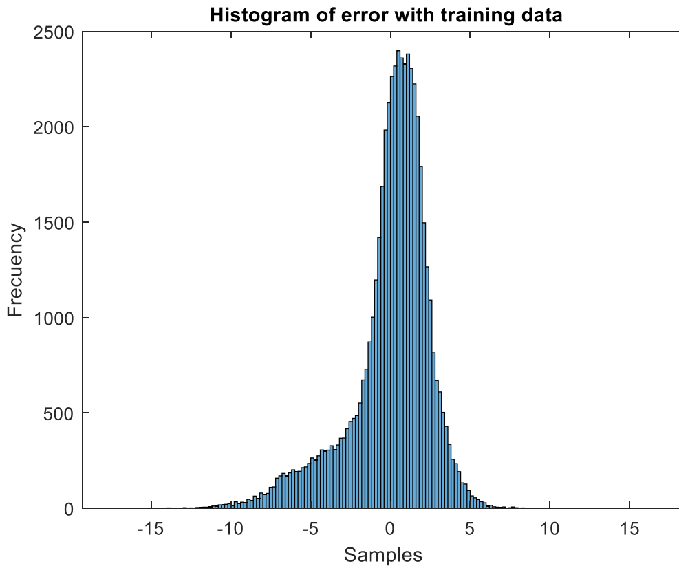
Figura 20. Modelo de la red neuronal perceptrón multicapa. Comportamiento de la temperatura del aceite de la multiplicadora con datos de entrenamiento. Histograma gaussiano del error del modelo
