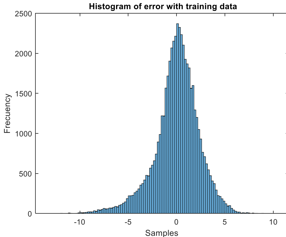
Figura 23. Modelo de la red neuronal perceptrón multicapa. Comportamiento de la temperatura del rodamiento de la multiplicadora con datos de entrenamiento. Histograma gaussiano del error del modelo
