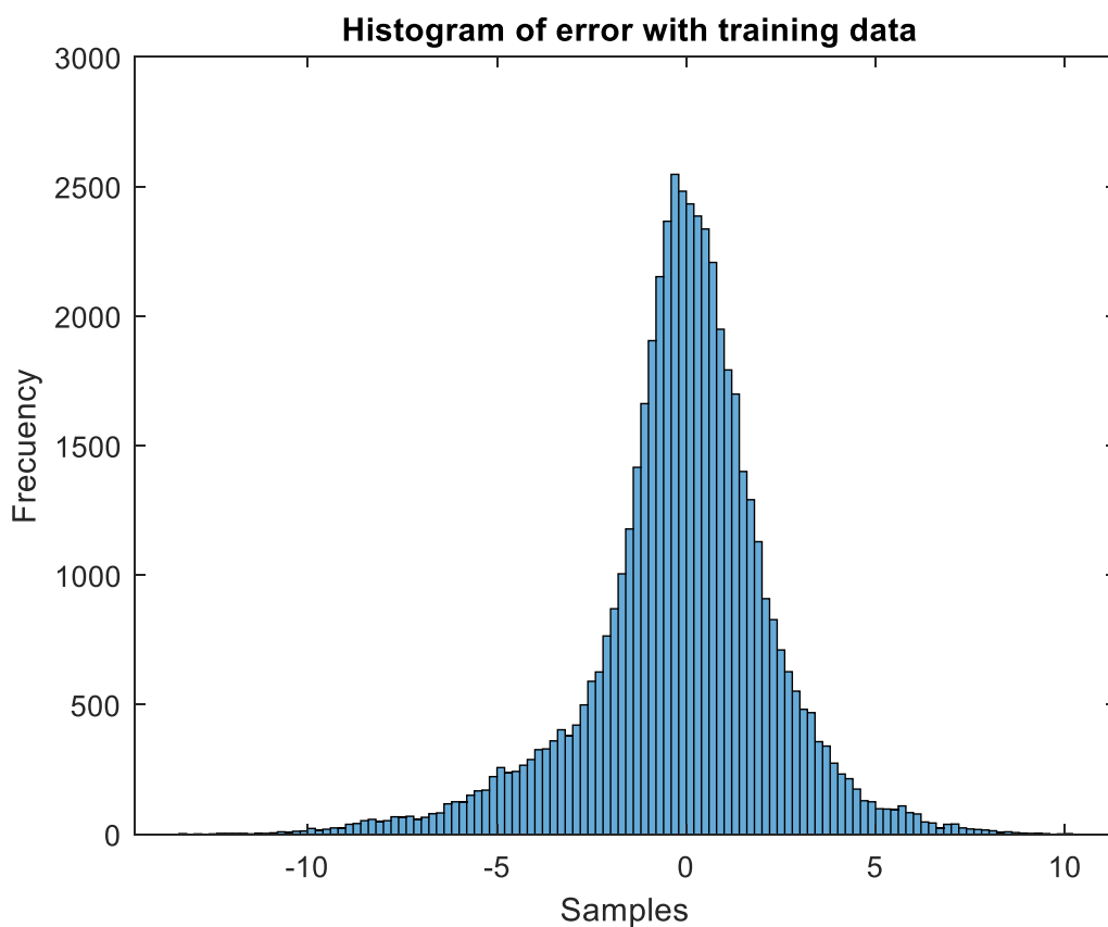
Figura 49. Modelo SVM. Comportamiento de la temperatura del rodamiento de la multiplicadora con datos de entrenamiento. Histograma gaussiano del error del modelo
