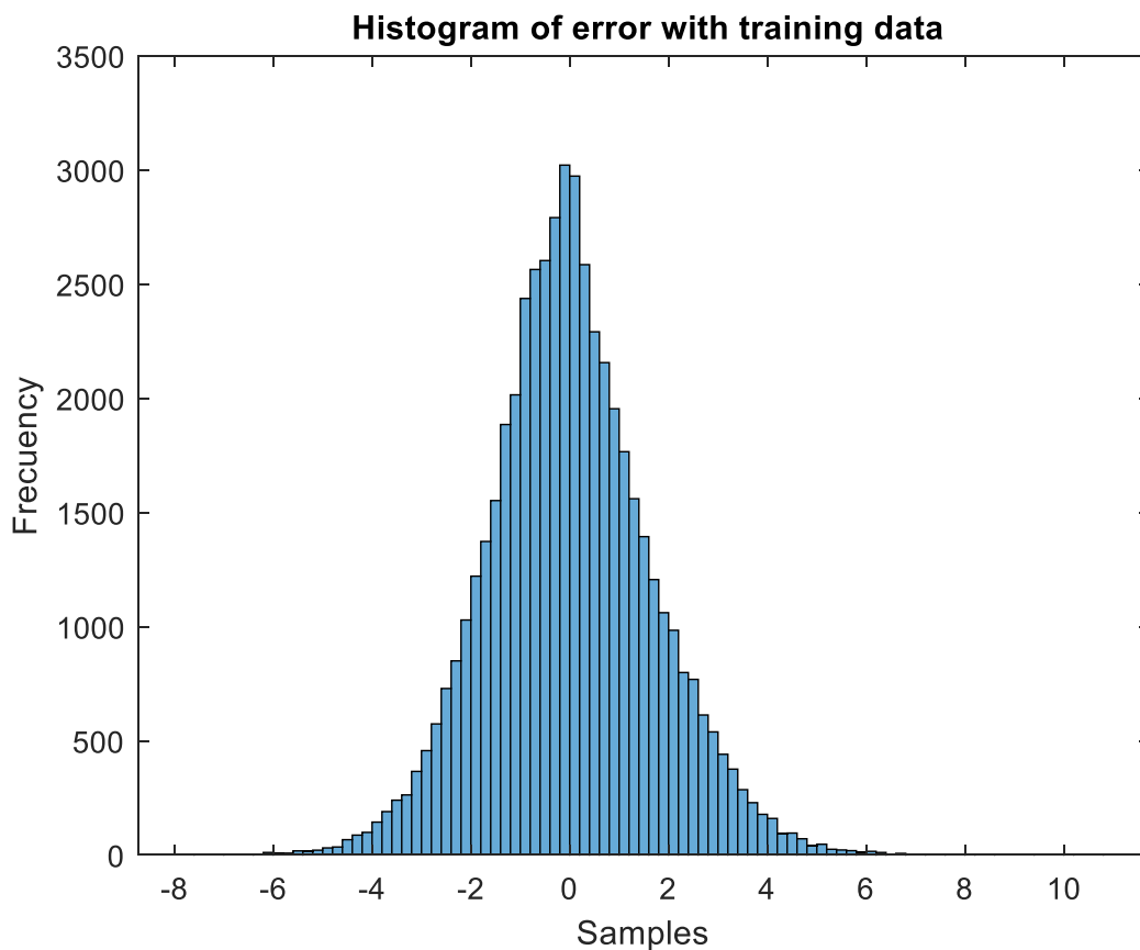
Figura 29. Modelo de la red neuronal RBF. Comportamiento de la temperatura de los anillos del generador con datos de entrenamiento. Histograma gaussiano del error del modelo
