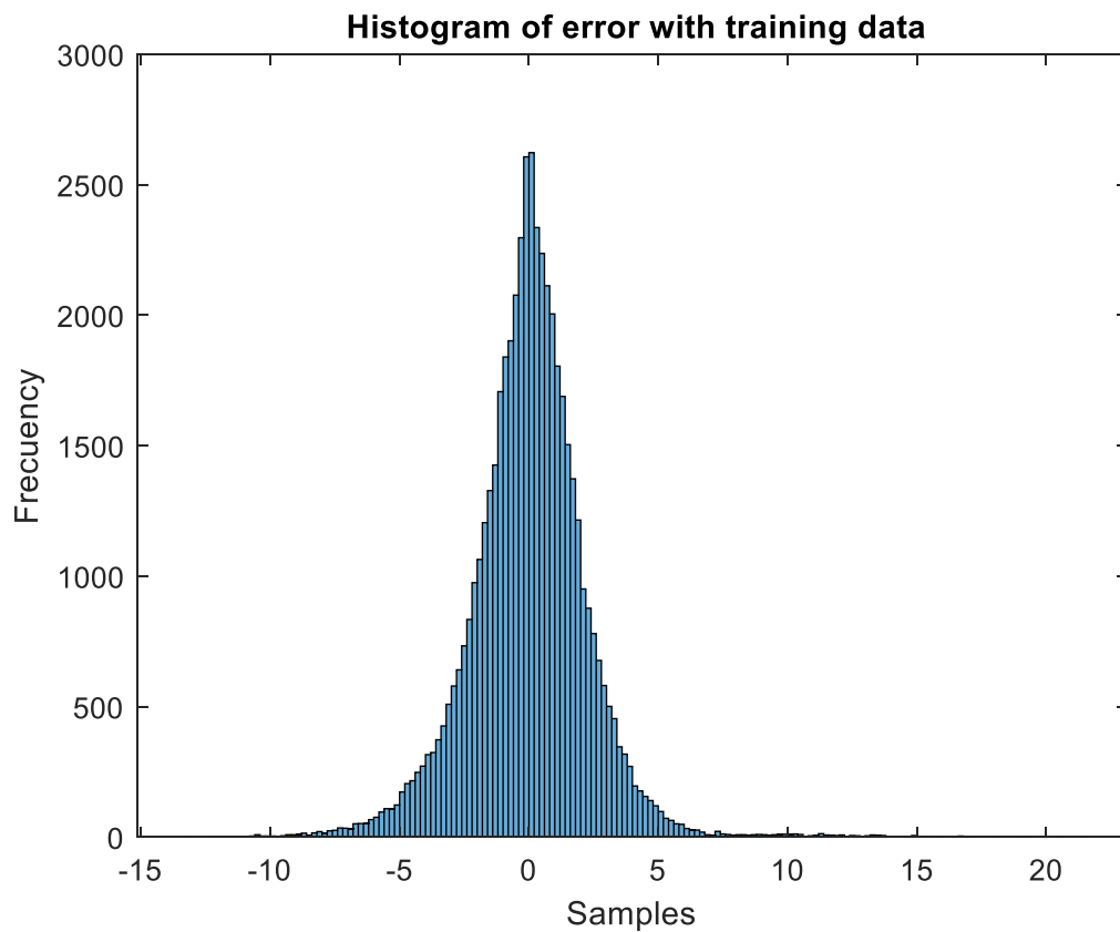
Figura 31. Modelo de la red neuronal RBF. Comportamiento de la temperatura del rodamiento DE del generador con datos de entrenamiento. Histograma gaussiano del error del modelo
