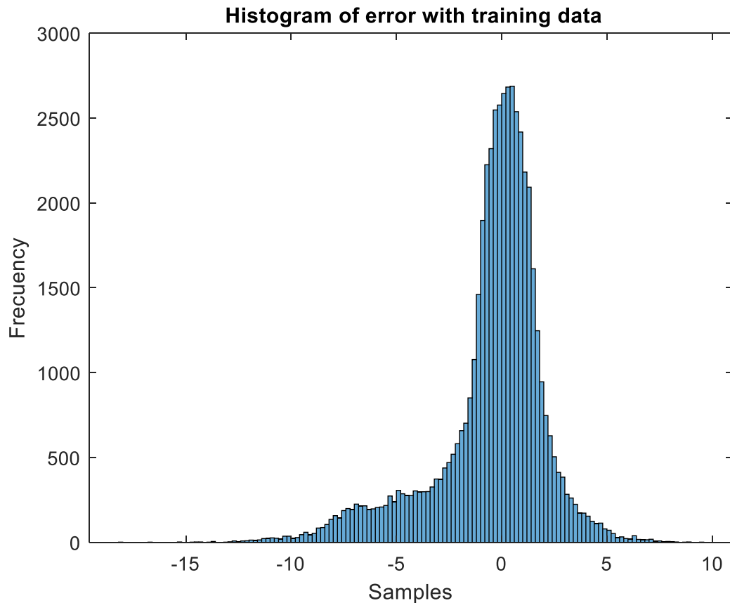
Figura 47. Modelo SVM. Comportamiento de la temperatura del aceite de la multiplicadora con datos de entrenamiento. Histograma gaussiano del error del modelo
