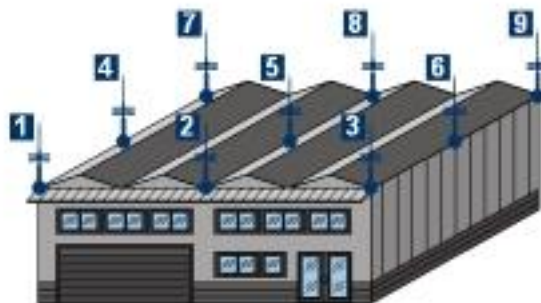
Fig. 7. Posibles situaciones del pararrayos en el edificio.
