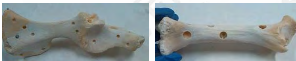
Figura 47 Huesos preparados para colocar el adhesivo y la esfera
