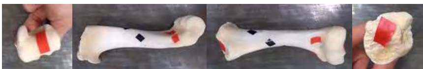
Figura 30 Colocación de las marcas en el hueso de cristal
