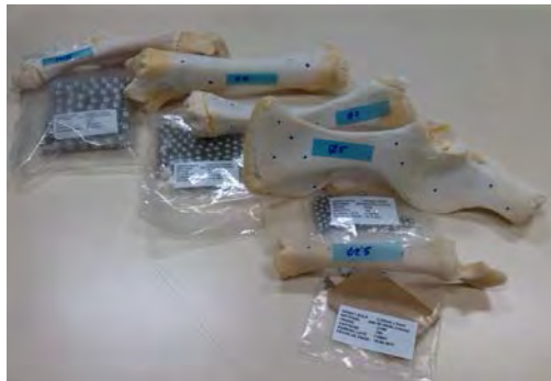
Figura 32 Huesos señalizados con rotulador y las esferas de acero a colocar.
