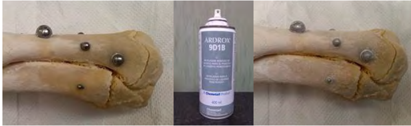
Figura 75 Proceso del revelador húmedo no acuoso
