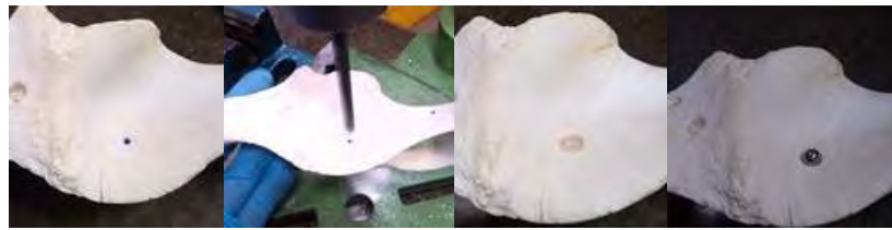
Figura 35 Secuencia de la operación de taladrado.
