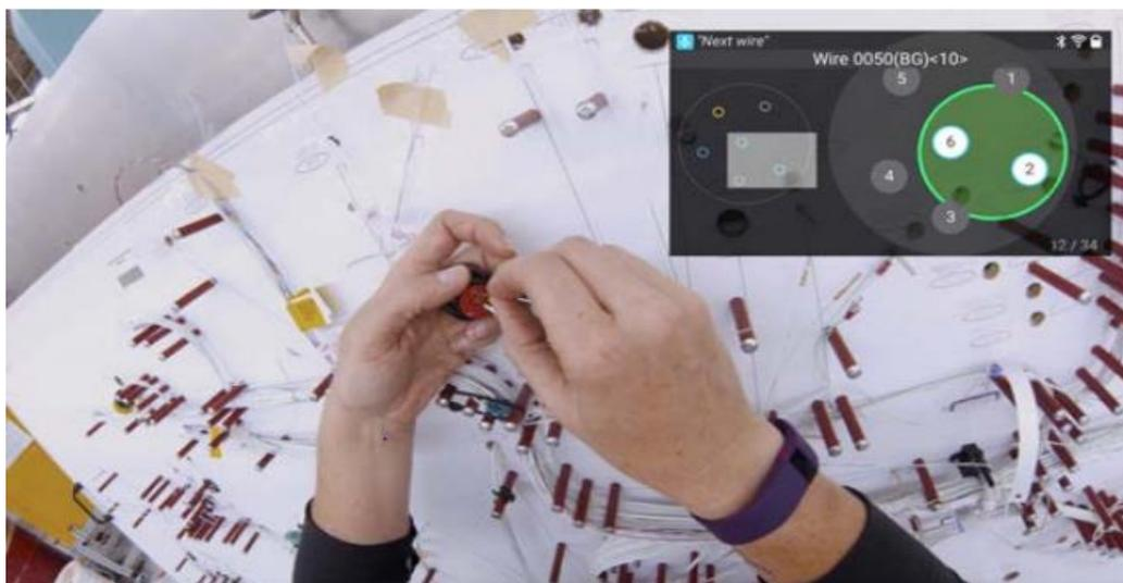
Imagen 11: Vista del técnico de Boeing usuario de las gafas inteligentes de Skylight. Fuente: Upskill (2018).
