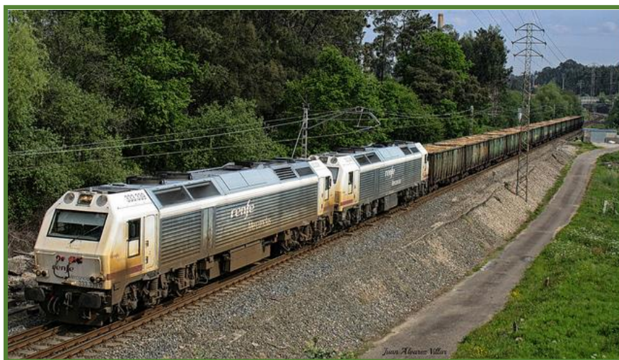
Dos locomotoras diésel serie 333.3 de Renfe con 3000CV cada una son necesarias para mover un corto tren de 14 vagones cargados de madera por Galicia .Servicio A Susana-Valença do Minho.
