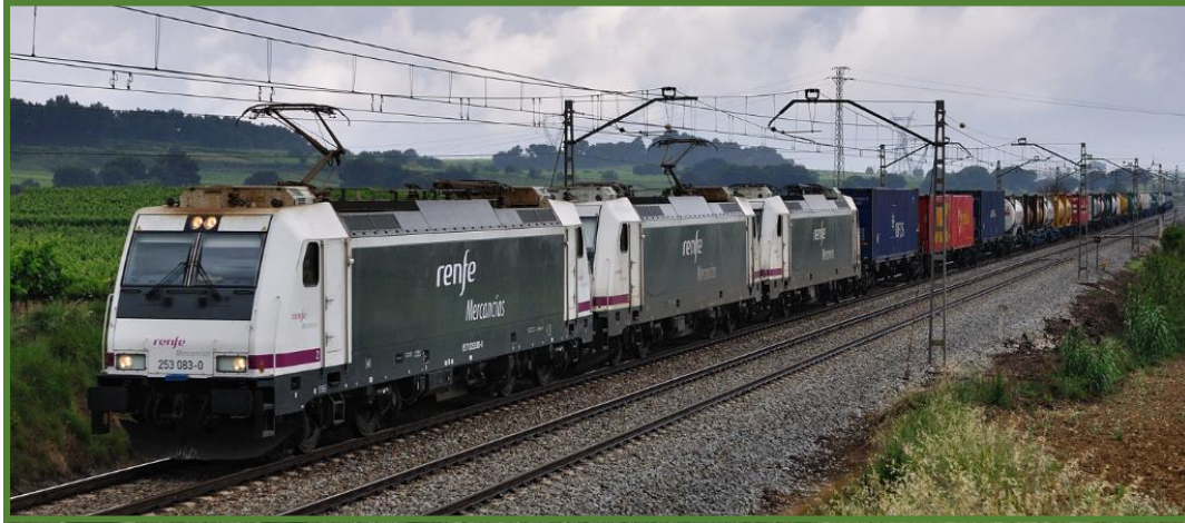
Los TLE 750 de Renfe exigen dobles tracciones generando además traslados de material.
