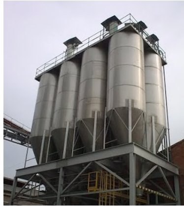
Figura 12. Ejemplo de Silo de Carga a Granel. Fuente: Silos de Córdoba (2018). Página web: siloscordoba.com.
