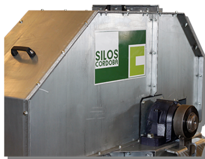
Figura 13. Ejemplo Elevador de cangilones. Fuente: Silos de Córdoba (2018). Página web: siloscordoba.com.
