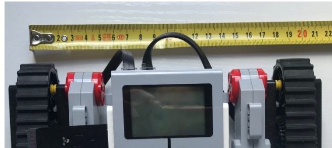
Figura 27: Imagen de la distancia entre ruedas en el EV3 utilizado
