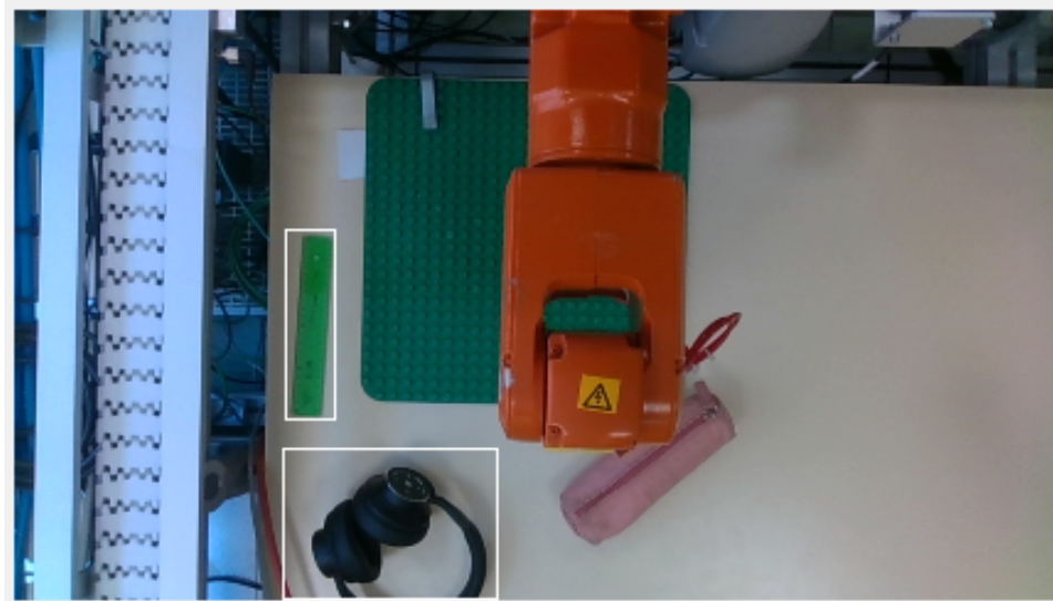
Figura 3.35: Ejemplo de fallo en el análisis de fotogramas por obstáculo no identificado.
