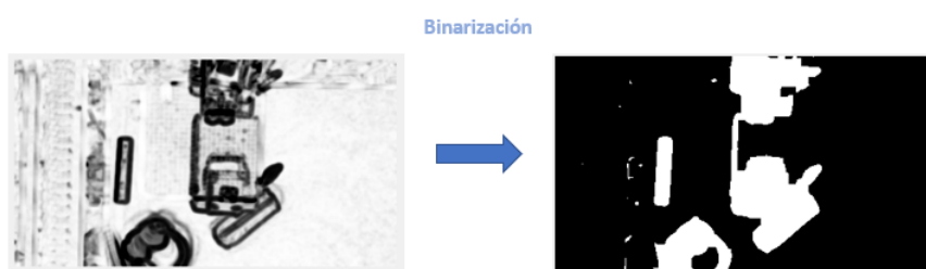
Figura 3.16: Objetivo a alcanzar en la etapa de binarización del mapa SSIM. A la izquierda aparece un ejemplo de resultado obtenido a la salida del algoritmo SSIM y a la derecha el resultado de binarizar este resultado.
