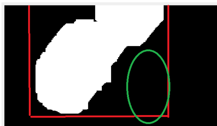
Figura 3.25: Resultado de localización de brazo del robot con método de análisis de blob . Sus coordenadas aparecen representadas en rojo y son inadecuadas pues esta recogiendo sección representada en verde sin ocupar.
