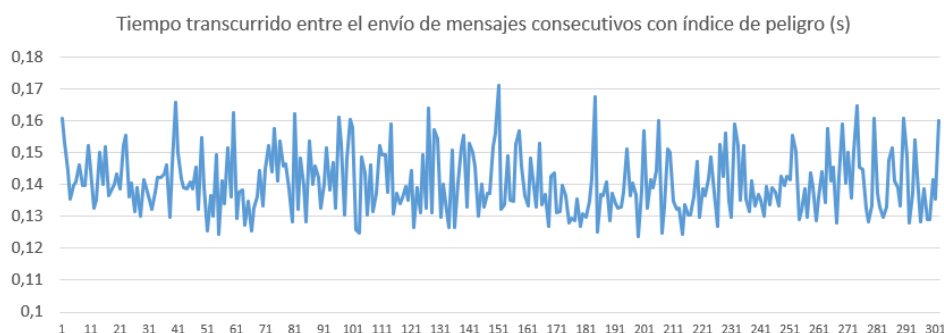
Figura 3.29: Tiempo transcurrido entre mensajes con informe de riesgo enviado al robot. Se han utilizado 300 muestras.
