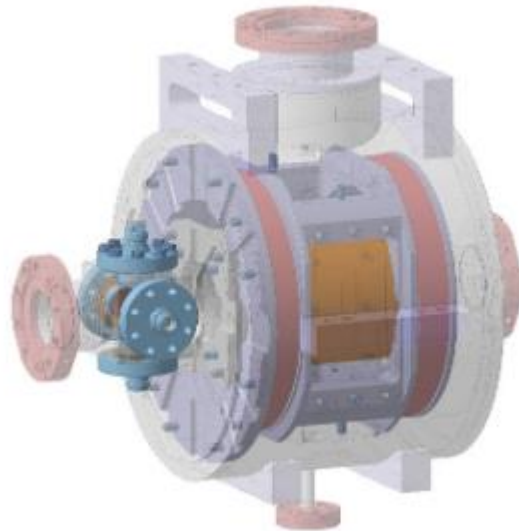
Ilustración 30: Diseño y fabricación de 16 paquetes de solenoides superconductores para el proyecto SARAF [52]
