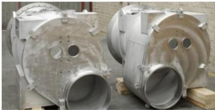
Ilustración 34: Componentes mecosoldados destinados a diferentes experimentos para el LHC en CERN [56]
