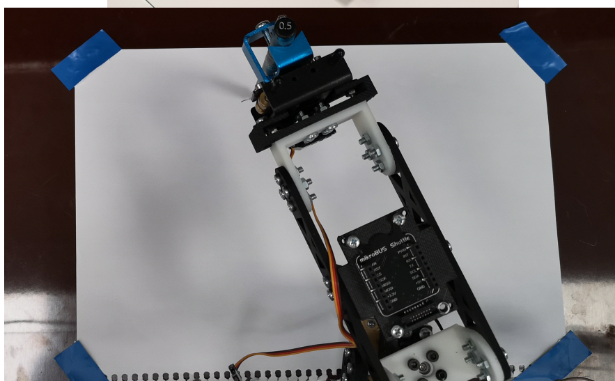
Figura 11 Montaje del brazo y el resto de componentes
