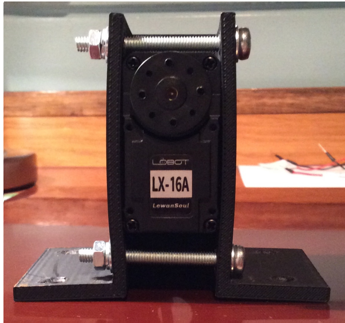
Figura 16: vista posición de los servos
