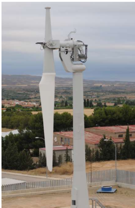
Imagen 10: Aerogenerador monopala. Fuente: ades.tv.
