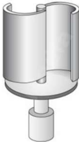
Imagen 6: Turbina savonius. Fuente: Wikipedia
