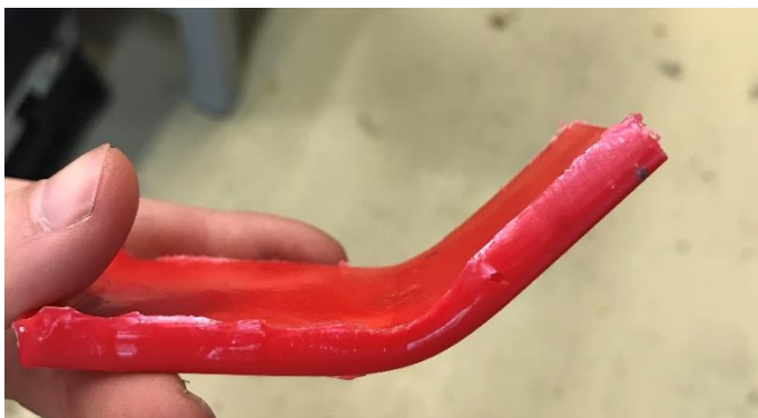
Figura 147: Probeta 2 flexionada de perfil
