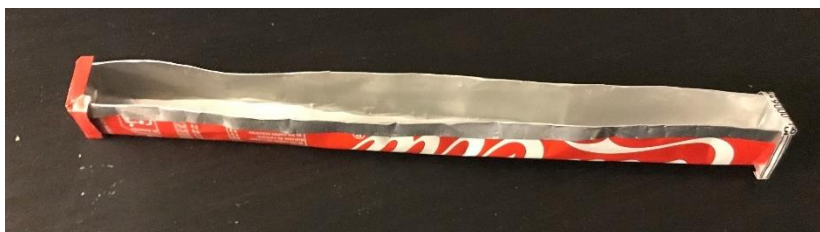
Figura 101: Molde de probeta
