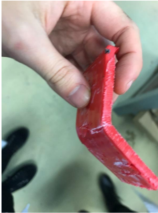
Figura 155: Probeta 3 con rotura
