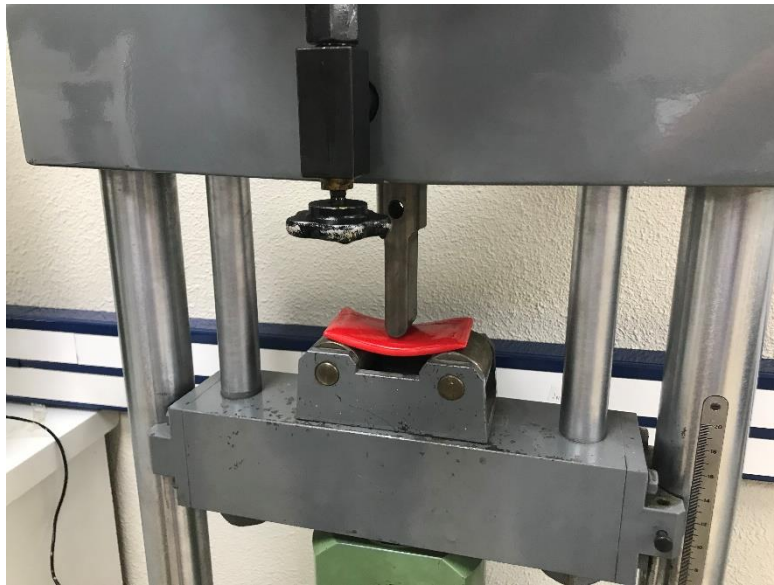
Figura 136: Probeta 1 durante la rotura
