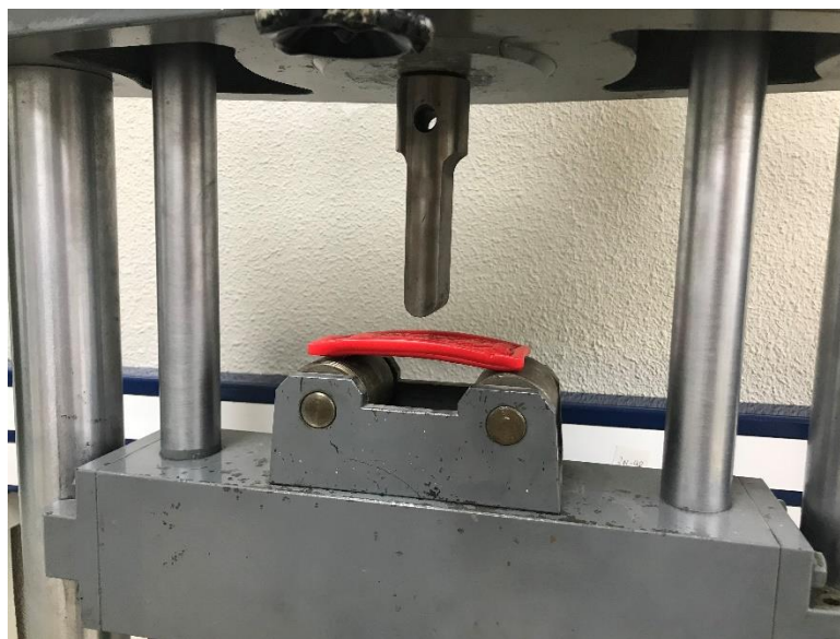
Figura 135: Probeta 1 antes de rotura
