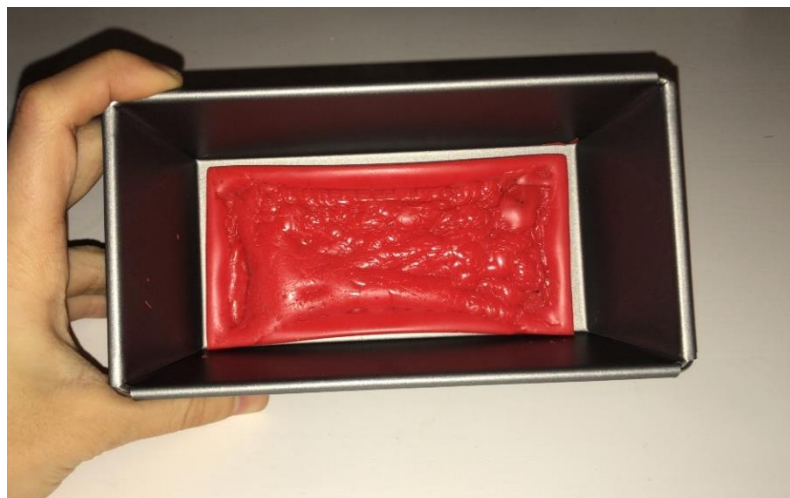
Figura 121: Probeta de flexión
