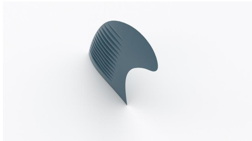
Figura 3-8: Perspectiva superior de la quilla modificada
