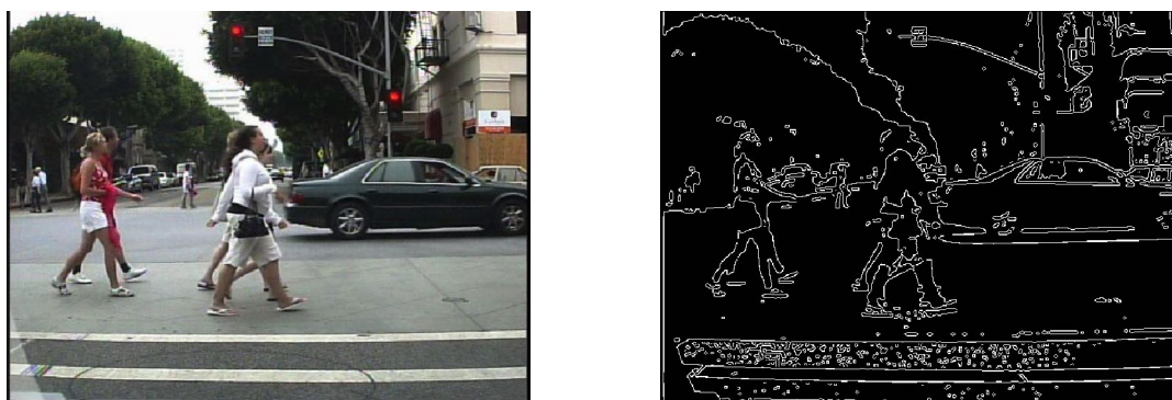
Figura 2.5. Resultado tras aplicar el operador de Canny. (Fuente: galería de imágenes de MATLAB)
