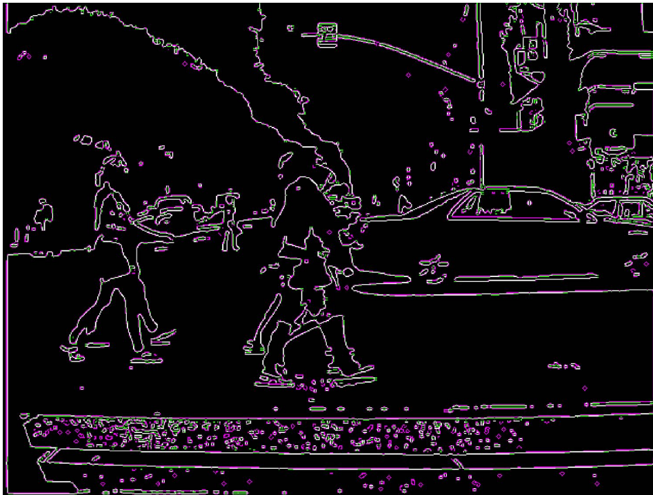
Figura 2.6. Comparativa de resultados al aplicar el algoritmo de Prewitt (verde) y Canny (morado). Las líneas blancas son aquellas en las que coinciden las detecciones de ambos algoritmos (Fuente: galería de imágenes de MATLAB).
