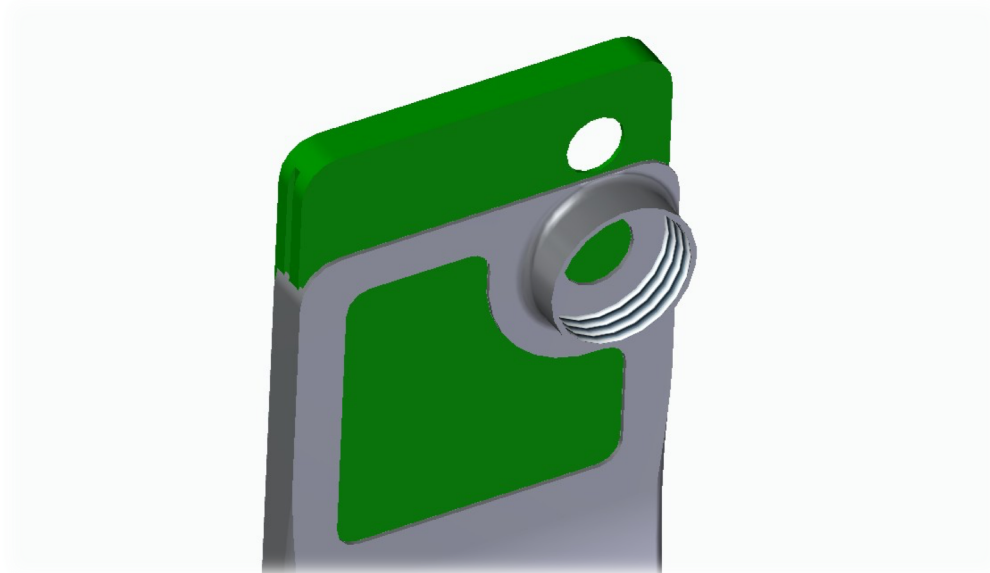
Figura E.5 Carcasa deslizando por los raíles de la placa base. Fuente: Elaboración propia 2019.
