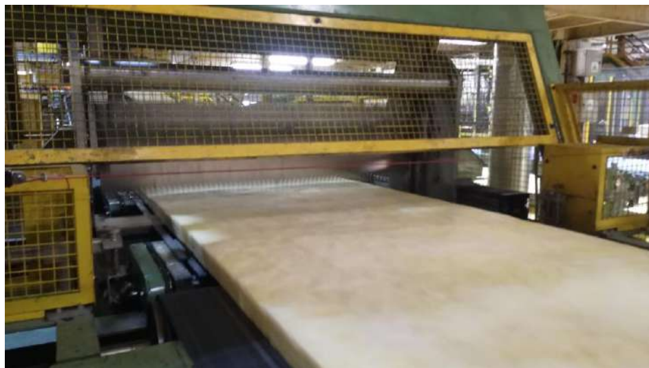
Figura 20: La guillotina realizando el corte transversal.
