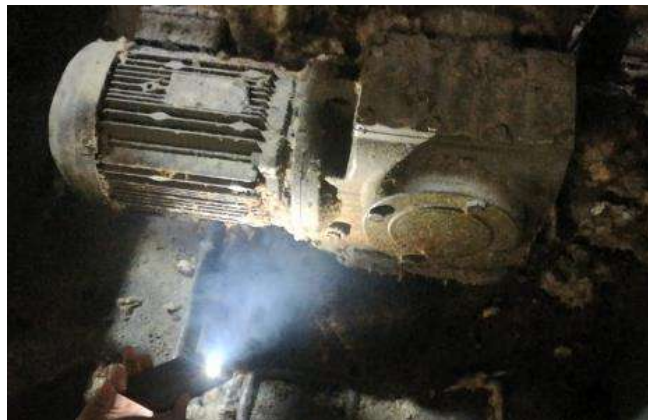
Figura 87: Escape de humo a través del hueco donde se encuentra el motor del cepillo.
