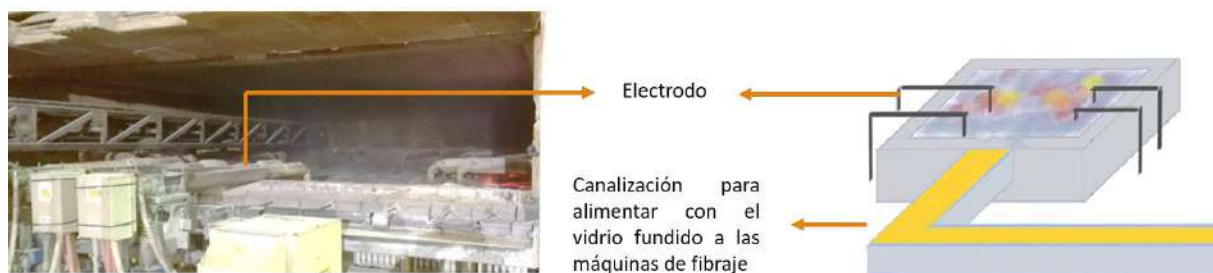
Figura 14: Representación real y esquemática del horno eléctrico.
