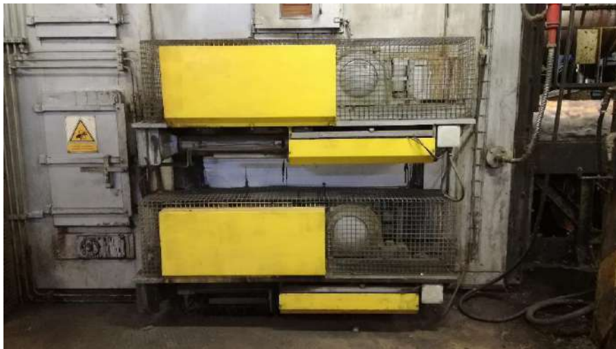
Figura 40: Sistema de tensado de las cadenas del transportador superior.
