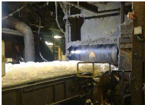
Figura 16: Colchón de lana obtenido en la recepción o salida de las máquinas de fibraje.
