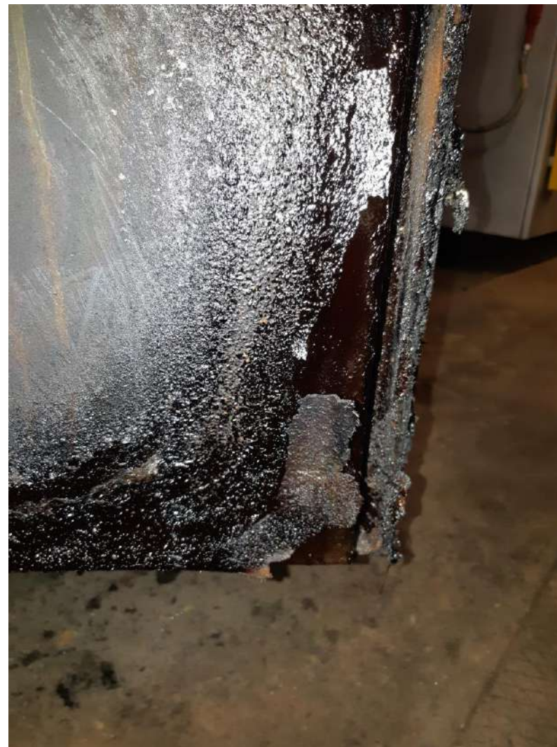
Acumulaciones de encolado y sellado de las puertas deteriorado
