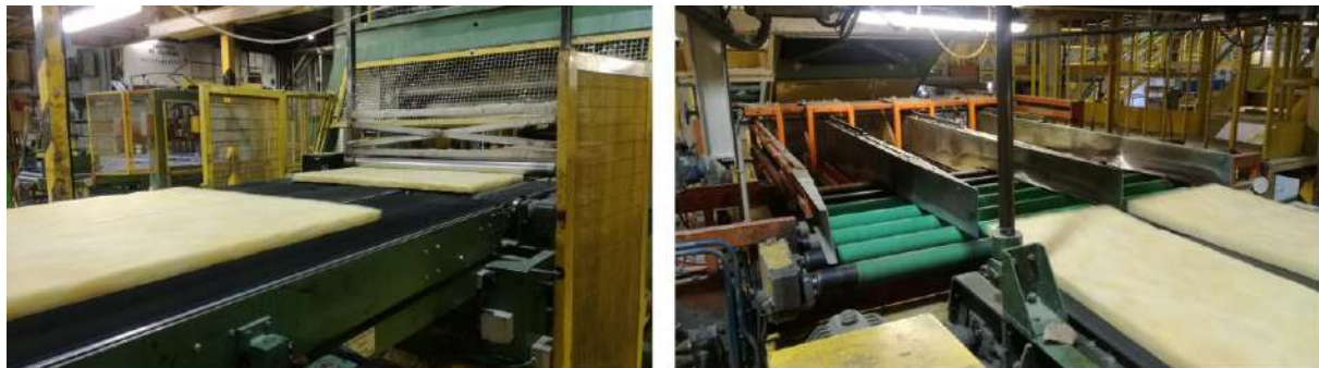
Figura 22: Producto cortado lateral, transversal y longitudinalmente.
