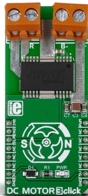
Figura 29 Generador de PWM (DC Motor 3 click)
