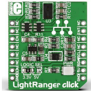
Figura 28 Sensor de posición por efecto de la luz
