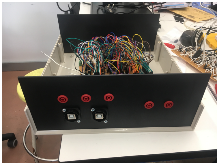
Figure 43. Caja sin montar: tapa con las conexiones
