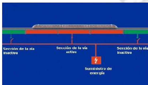
Figura 25. Esquema del diseño fraccionado de la vía.
