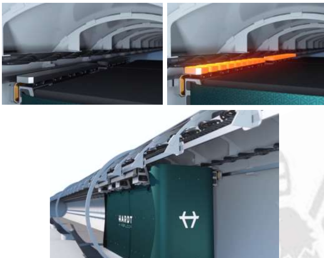
Figura 33. Levitación magnética con electroimanes en parado e imanes permanentes en movimiento.
