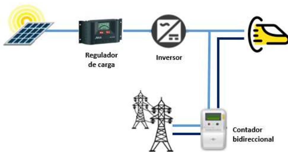
Figura 72. Esquema instalación. Fuente: Elaboración propia.
