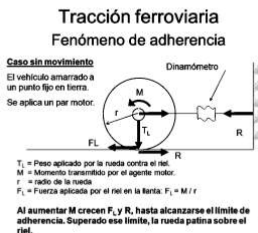
Figura 12. Diagrama de fuerzas. Fenómeno de adherencia. Fuente: [3]
