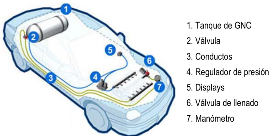
Imagen 21: nuevos componentes del vehículo para el uso de GNC. [12]
