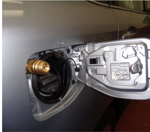
Imagen 29: disposición de la toma de llenado de GLP. [32]
