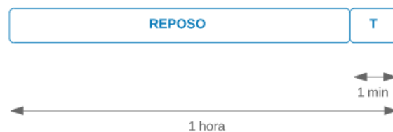
Figura 25. Ciclo de transmisión del data logger. Fuente: Elaboración propia.
