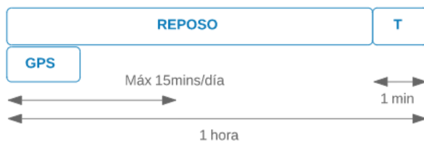
Figura 26. Ciclo de transmisión del transmisor GOES. Fuente: Elaboración propia.
