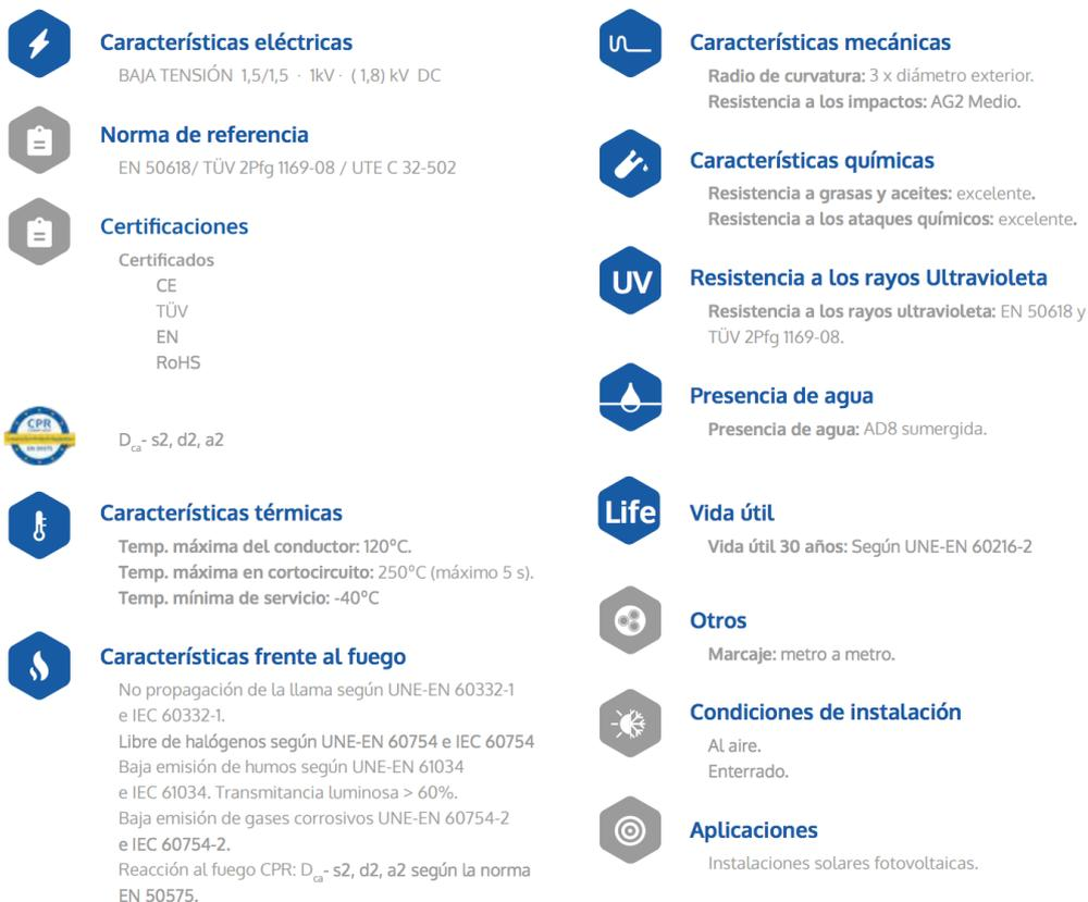
Figura 18.- Características técnicas del cable para instalación solar fotovoltaica.
