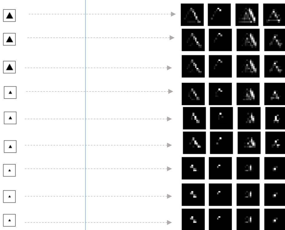
Figura 20 Mapas de activación para el modelo 2-4 filtros indicado en la tabla. 4 de los triángulos.
