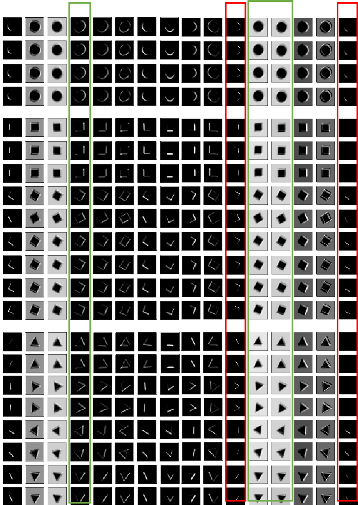
Figura 26 Mapas de activación de la primera capa de 16 filtros, para el modelo 16-16
