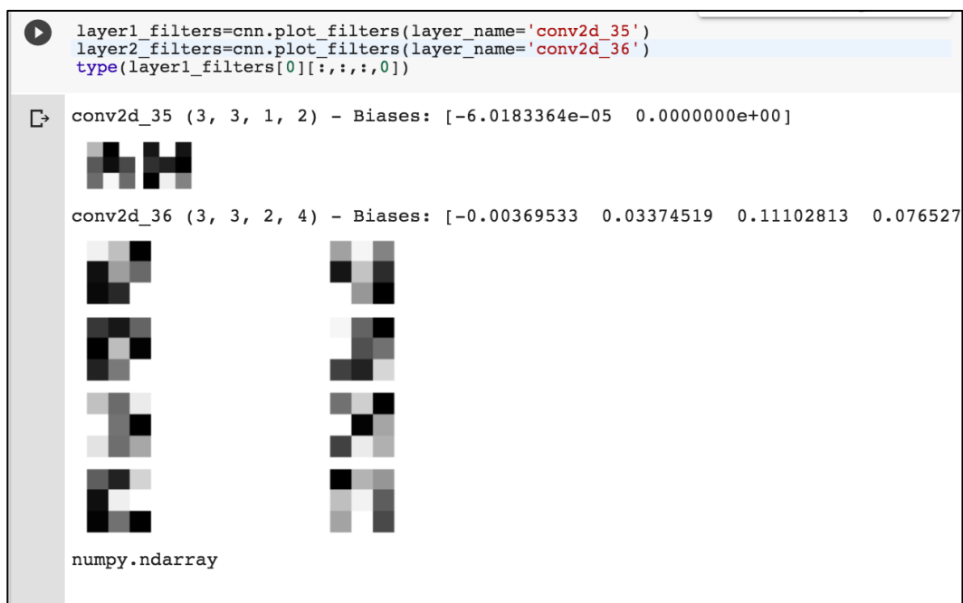
Figura 30 Obtención de los pesos para la aplicación del método L1-norm
