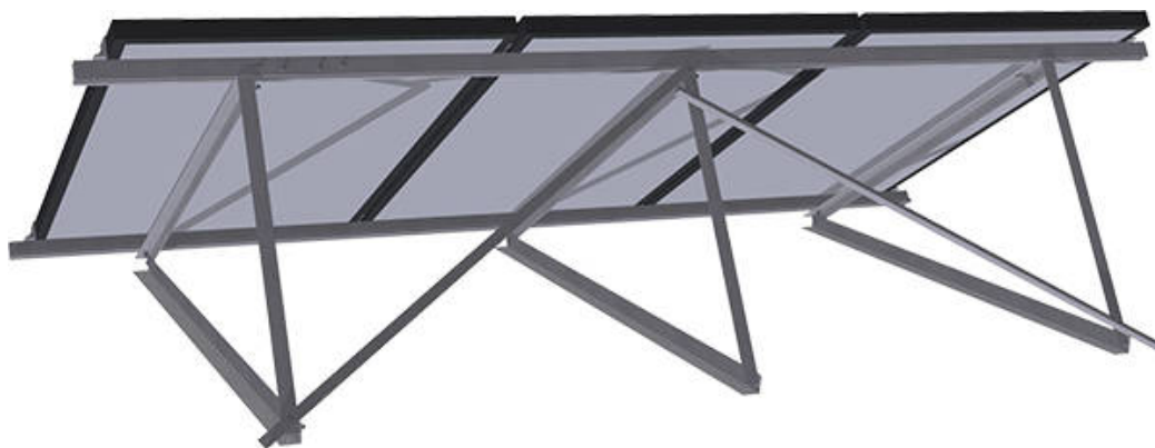
Figura 18. Estructura para paneles solares sobre suelo.
