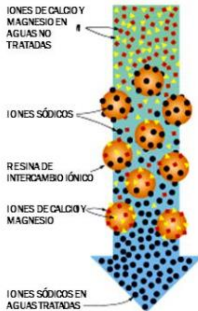
Figura 39: Técnica de ablandamiento del agua: intercambio iónico. (Fuente: Condair)
