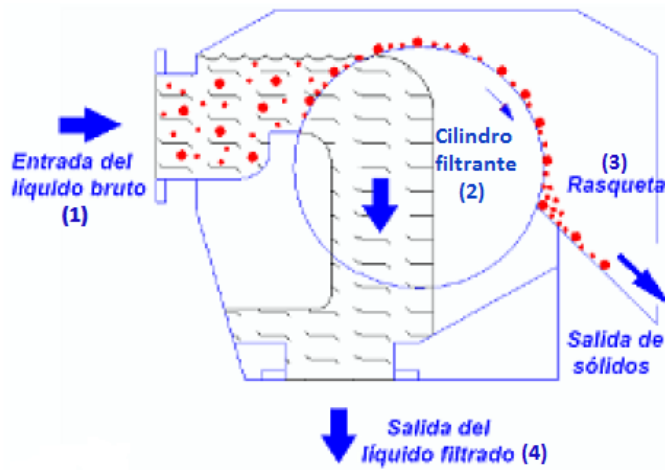
Figura 27: Tamiz rotativo. (Fuente: GEDAR-Tratamiento de aguas)
