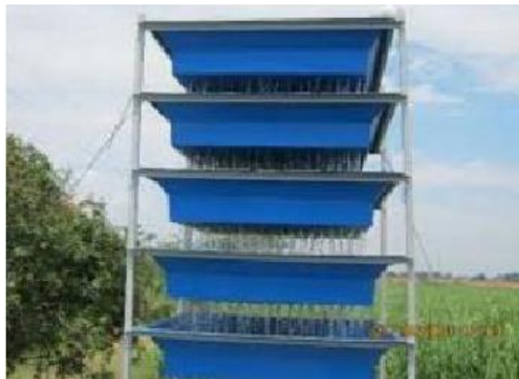
Figura 30: Aireador de bandejas múltiples (Fuente: (Sebastián, 2017))
