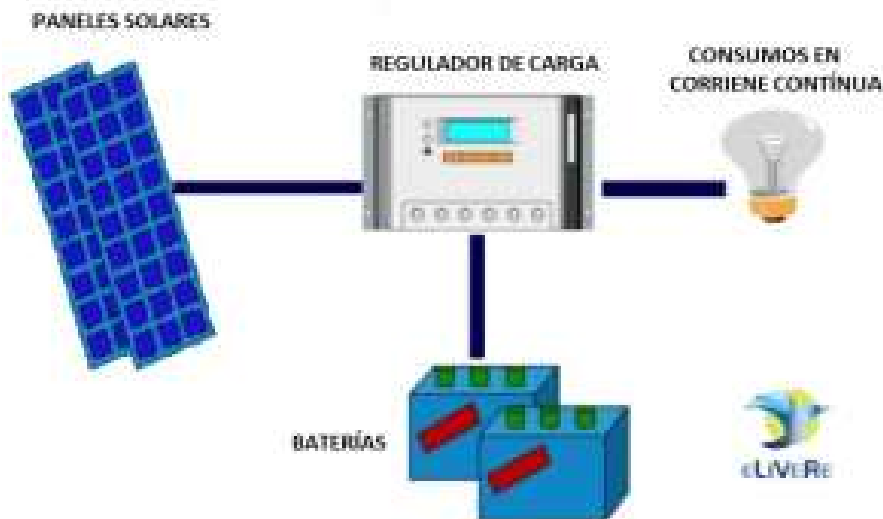
Ilustración 6: Esquema básico de una instalación de autoconsumo en isla para cargas en CC
