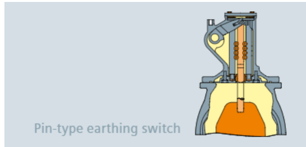
Fig. 22: Seccionador de puesta a tierra
