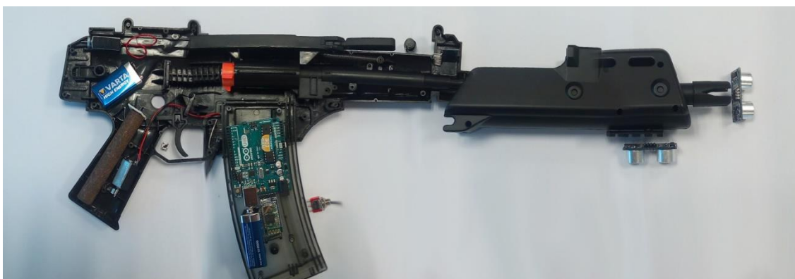
Figura 28: Esquema general de la disposición de los distintos módulos en el arma una vez abierta.
