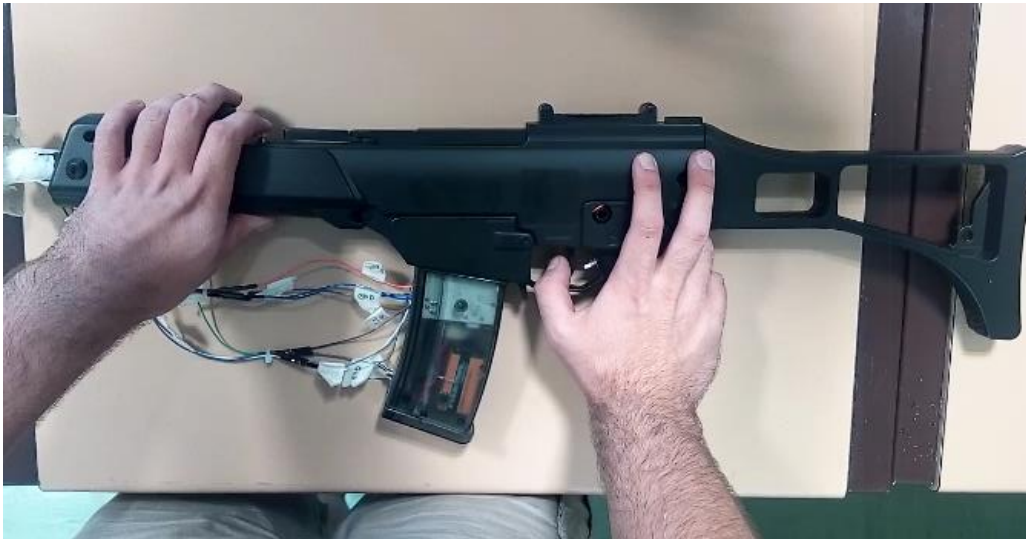
Figura 70: Arma inmovilizada contra la mesa para asegurar la ausencia de vibraciones, una mano se colocara en el gatillo y otra en el boton de recarga.
