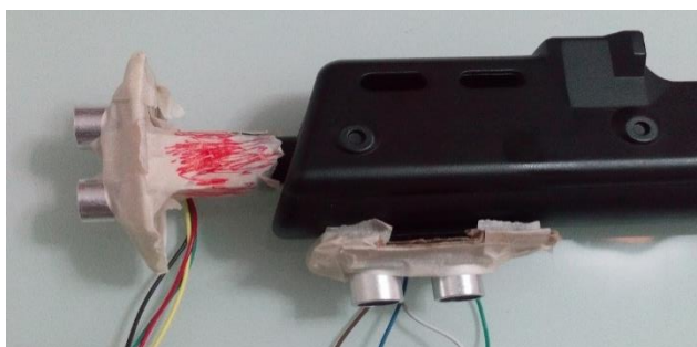
Figura 37: Imagen de los sensores una vez colocados y fijados a la boca del arma.
