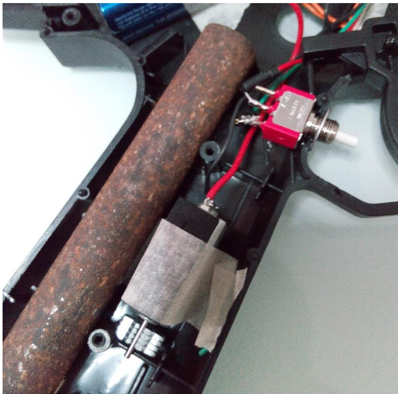
Figura 33:Detalle de la colocación de uno de los motores en el mango del arma
