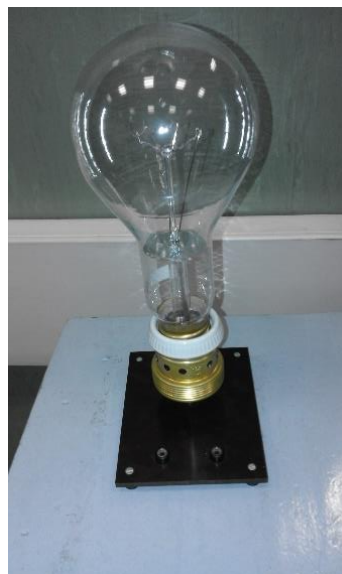
Ilustración 5-3: Bombilla que simula el consumo de un usuario.
